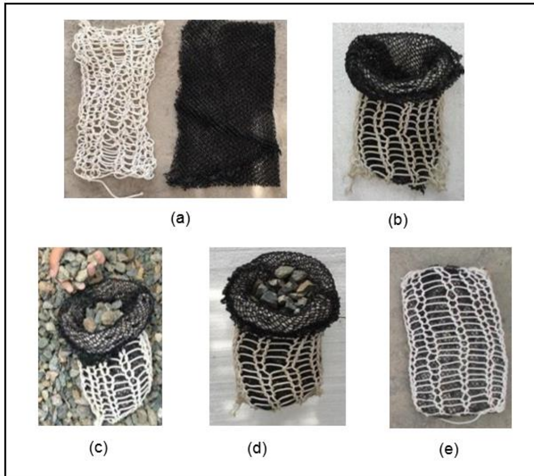
Figura 12 Construcción del Ensamble de Shicras Elíptica (Fuente: Proyecto Estudio de Aislamiento Sísmico de Viviendas Rurales Mediante Sobrecimientos con Shicras, 2017. En proceso de publicación)
