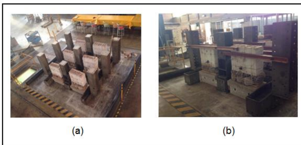
Figura 41 Colocación e instalación de muros sobre el simulador sísmico
