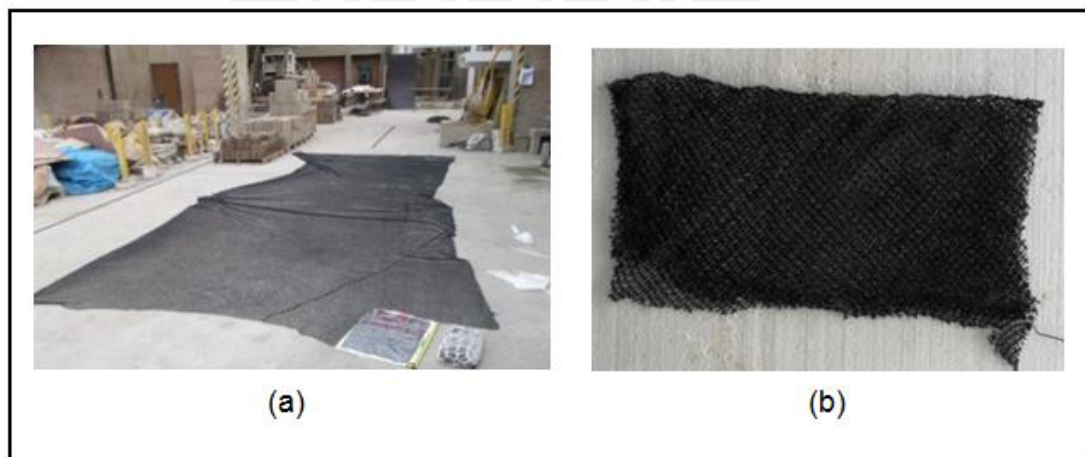
Figura 10 Tejido de Shicra de malla negra de pescador (Fuente: Proyecto Estudio de Aislamiento Sísmico de Viviendas Rurales Mediante Sobrecimientos con Shicras, 2017. En proceso de publicación)
