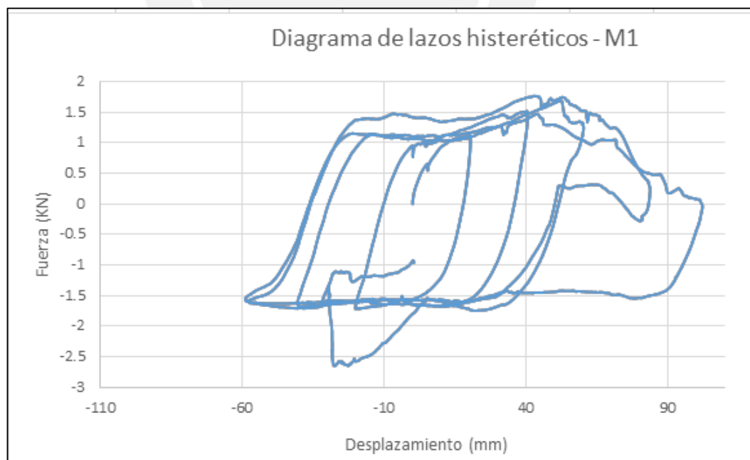
Figura 48 Diagrama de fuerza – desplazamiento del sobrecimiento con piedras 1/2"
