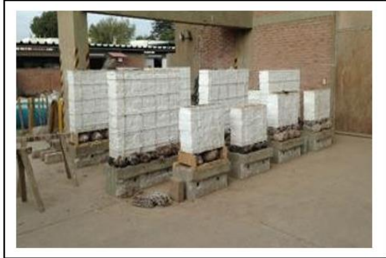
Figura 5 Presentación de muros de adobe pintados con Temple blanco (Fuente: Estudio de Aislamiento Sísmico de Viviendas Rurales mediante Sobrecimientos con Shicras. MVCS, 2017. En proceso de publicación)
