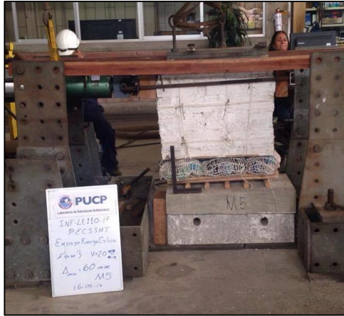
Figura 55 Ensayo de carga cíclica del M5.
