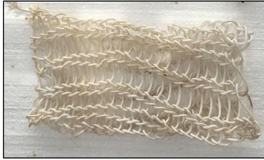
Figura 9 Shicra de driza blanca (Fuente: Proyecto Estudio de Aislamiento Sísmico de Viviendas Rurales Mediante Sobrecimientos con Shicras, 2017. En proceso de publicación)
