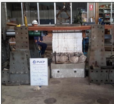
Figura 49 Ensayo de carga cíclica del muro M2
