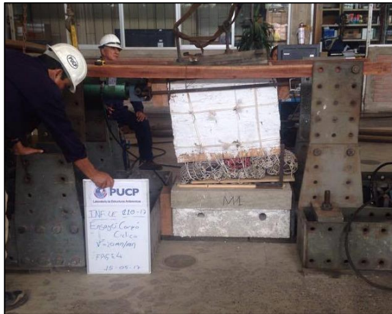
Figura 47 Ensayo de carga cíclica del muro M1.
