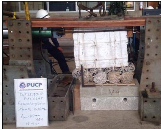
Figura 53 Ensayo de carga cíclica del muro M4
