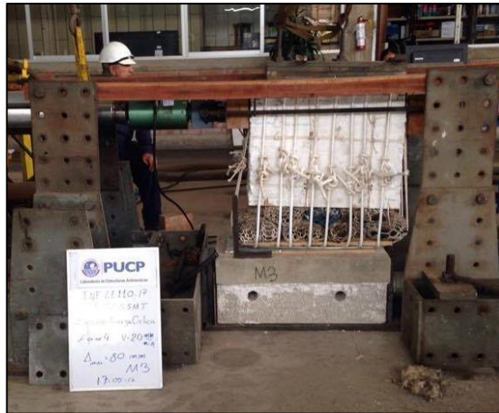
Figura 51 Ensayo de carga cíclica del muro M3
