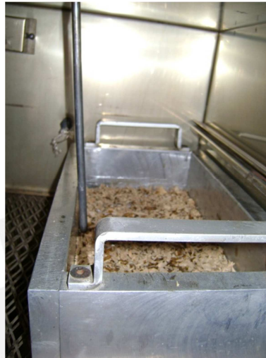
Figura 1.19.e Mezcla a 130°C, tiempo de permanencia [Proyecto del Investigación PUCP]
