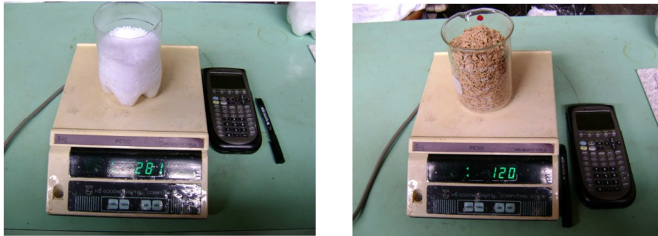
Figura 1.19.a Determinación del porcentaje en volumen de los componentes del material compuesto [Proyecto del Investigación PUCP]
