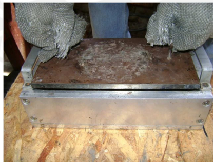
Figura 1.19.f Fijación de la tapa del molde [Proyecto del Investigación PUCP]
