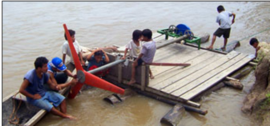
Figura 1.10 1 Prueba de una turbina de río “aquacharger”
