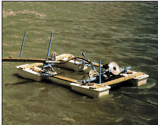
Figura 1.9 Turbina Garman utilizada para el bombeo de agua [Ramirez, 2002]
