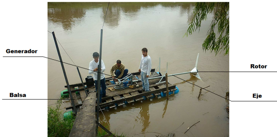
Figura 1.1 Turbina de río ( aquacharger ) en prueba en río caudaloso (Colombia) [Aprotec]
