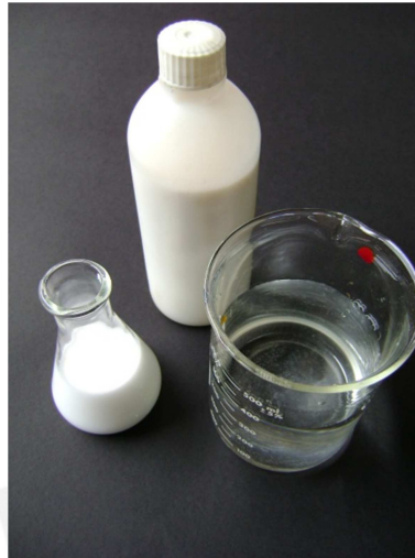
Figura 1.19.c Dilución de desmoldeante líquido [Proyecto del Investigación PUCP]
