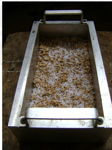
Figura 1.19.d Mezcla colocada en el molde [Proyecto del Investigación PUCP]
