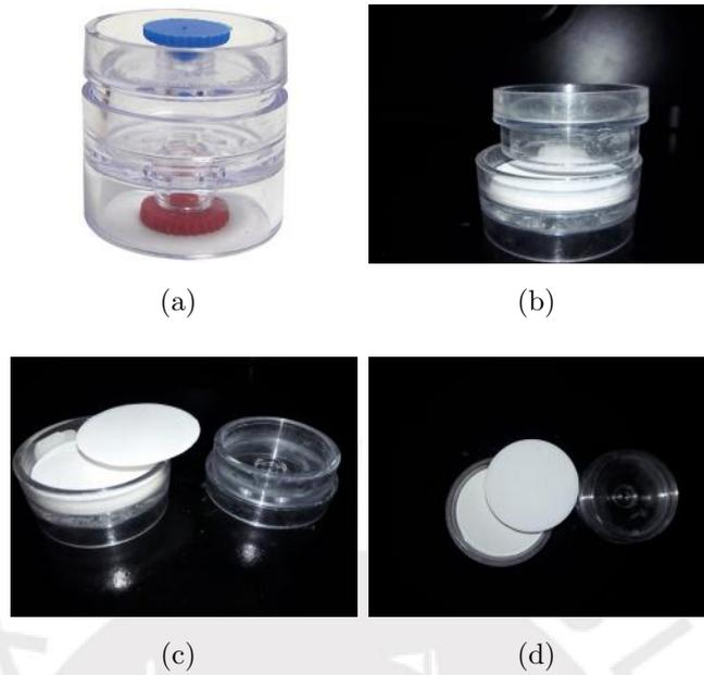
Figura 3.5: (a) Casete vacío y (b), (c) y (d) casetes con porta-filtro y filtro
