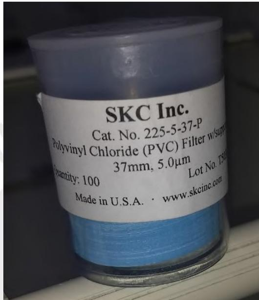
Figura 3.4: Filtro de PVC de tamaño de poro de  $5 \mu\text{m}$
