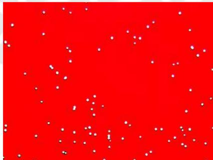
Figura 3.10: Detector LR-115 expuesto a una fuente de americio 241
