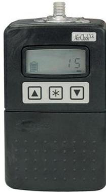
Figura 3.2: Bomba de muestreo de aire personal marca SKC de flujo constante, modelo AIRCHECK XR5000 configurado a 1,7 L/min 3.2
