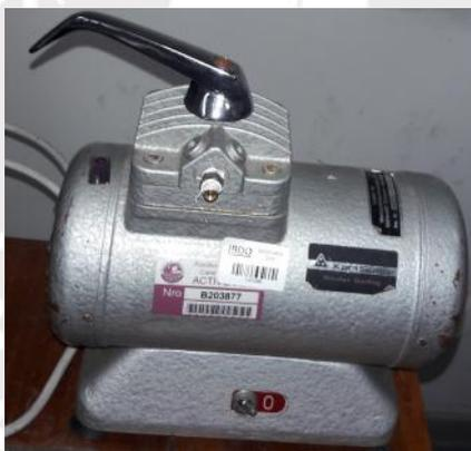
Figura 3.1: Bomba de vacío, marca KARL SUSS MÜNCHEN GARCHING, modelo AL 017 L
