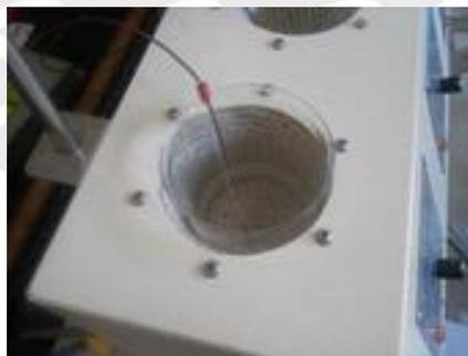
Figura 3.8: Baño termostático con configuración graduable
