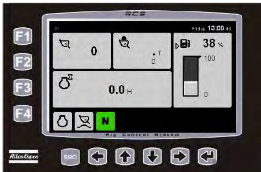
Figura 2.5 – Panel de control de cargador frontal de bajo perfil (Fuente sistema RCS de Atlas Copco)
