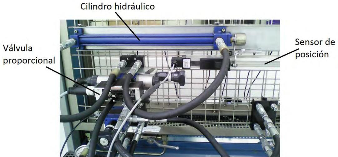
*Figura 3.9 – Conexión oleohidráulica entre la válvula proporcional y el cilindro hidráulico*
