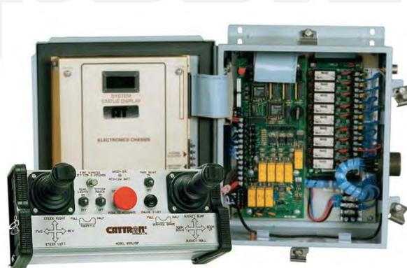
Figura 2.3 – Equipo receptor de señal (Fuente: CATTRON Group International)
