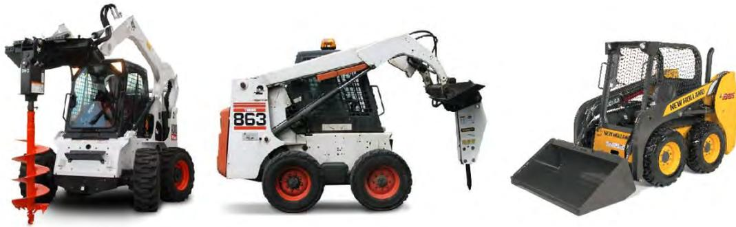
Figura 1.2 – Aplicaciones del Mini Cargador
