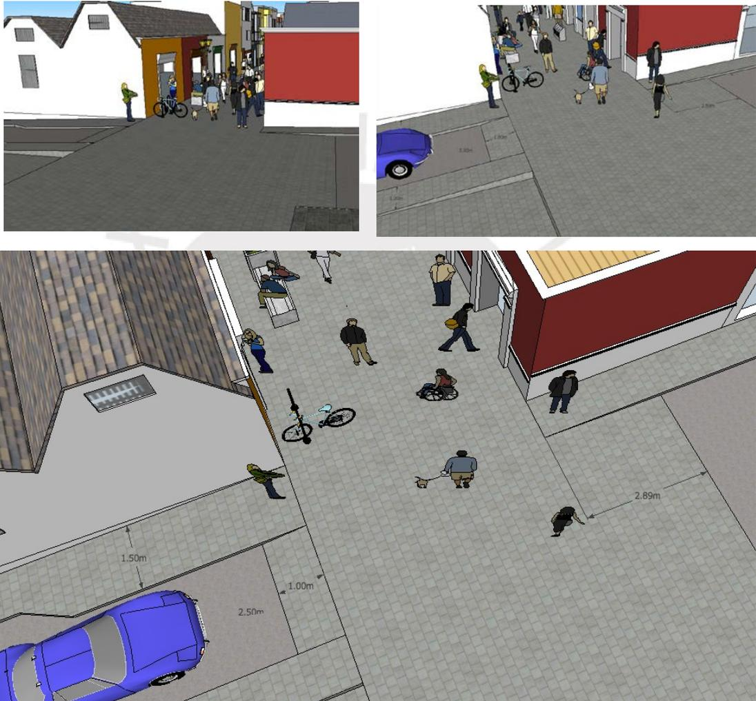
Figura 47. Sistema de control de velocidad para intersecciones. Elaboración propia.
