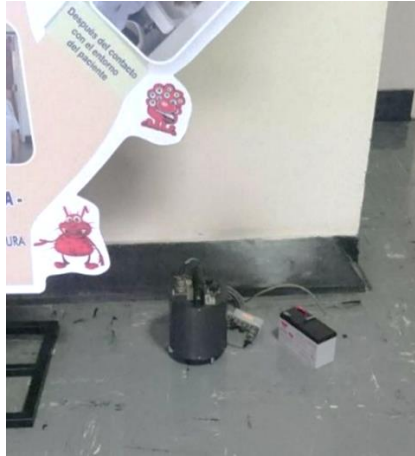
Figura 3-8 Toma de medición de vibraciones con sismógrafo Güralp 6TD
