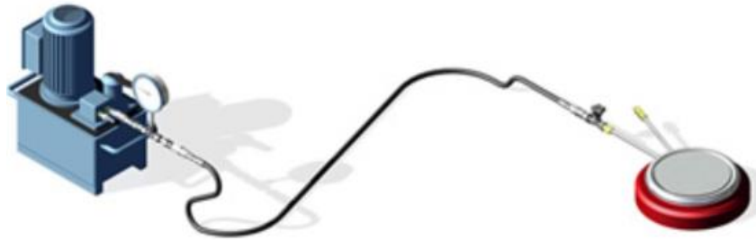
Figura 6-19 Bombeo del epóxico
