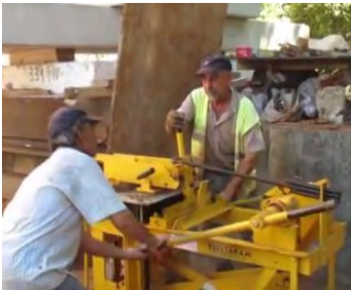
(c) Compresión con prensa
