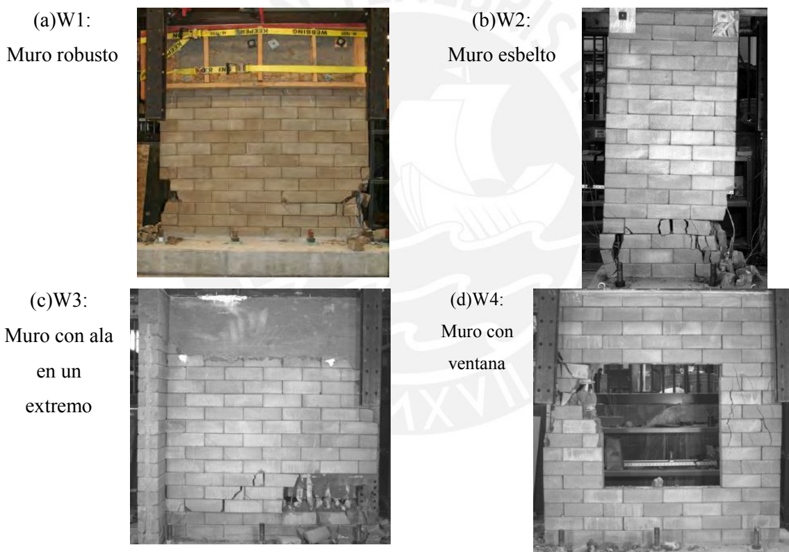
Figura 2.19 Especímenes después del ensayo y envolventes de la curva de histéresis (Qu et al., 2015)
