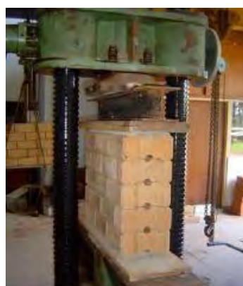
(b)BTC con indentaciones y con ranura horizontal
