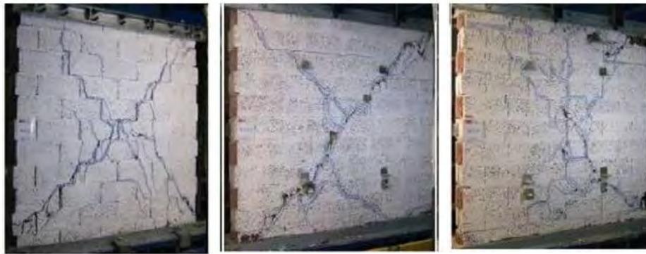
(a) Patrones de agrietamiento experimental
