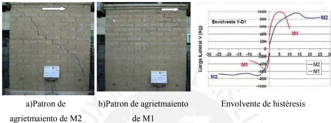
Figura 2.20 Ensayos de corte cíclico (Villon & Castillo, 2013)
