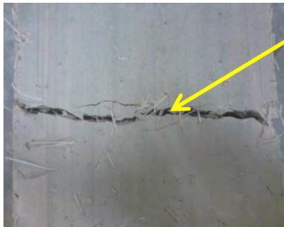
(a) Falla dúctil en ensayo de flexion
