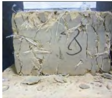
(b) Falla dúctil en compresión
