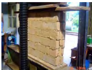
(a)BTC con indentaciones y alveolos verticales
