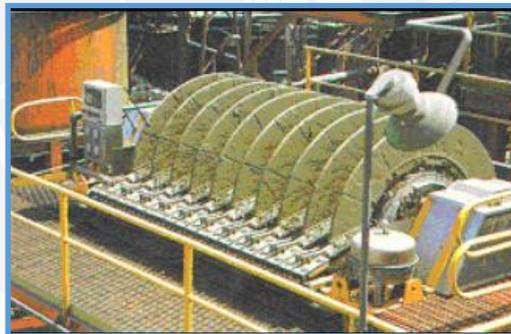
Figura 0.8. Filtro de discos al vacío.
