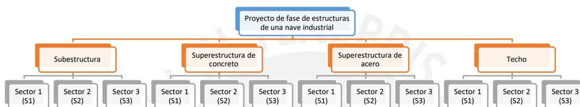
Figura 51: LBS del proyecto de fase de estructuras de una nave industrial (elaboración propia)
