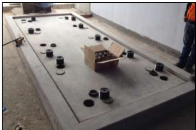
Fotografía 28: Se puede apreciar el retiro de los casting de compresión con una herramienta especial, asimismo se debe retirar la base de neopreno como se observa en la imagen inferior derecha.
