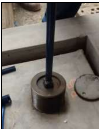
Fotografía 28: Se puede apreciar el retiro de los casting de compresión con una herramienta especial, asimismo se debe retirar la base de neopreno como se observa en la imagen inferior derecha.
