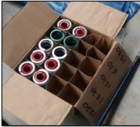
Fotografía 29: Podemos observar los resorts codificados según planos, cada uno de ellos con diferente rigidez los cuales irán distribuidos dentro de los moutings.
