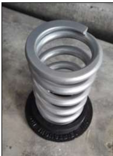
Fotografía 09: Montaje de resortes sobre la base de neopreno Fuente: FASE DOS SAC
