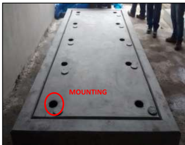
Fotografías 07 y 08: Retiro del casting de compresión Fuente: FASE DOS SAC
