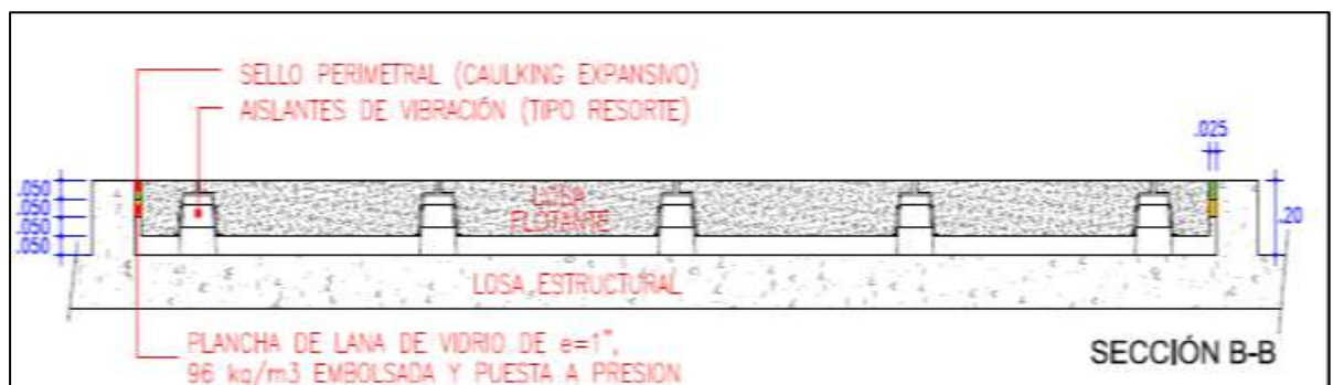
Imagen 04: Detalle de losa flotante nivelada para montaje de equipos Fuente: FASE DOS SAC
