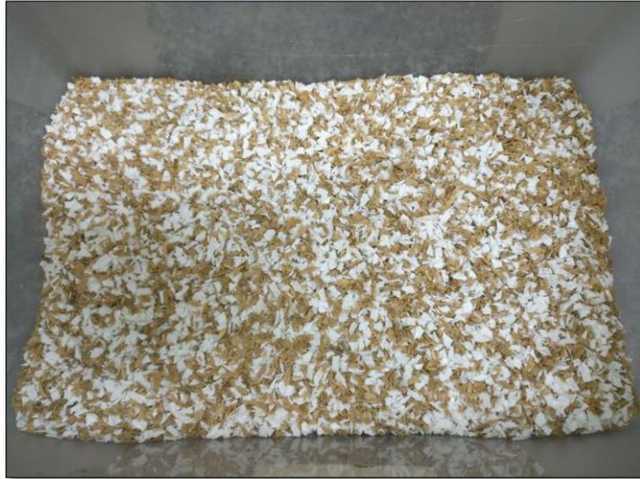
**Figura 2.16.** Mezcla Homogénea del plástico-madera
