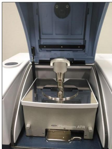
**Figura 2.9.** Proceso de ensayo de FTIR-ATR del polietileno
