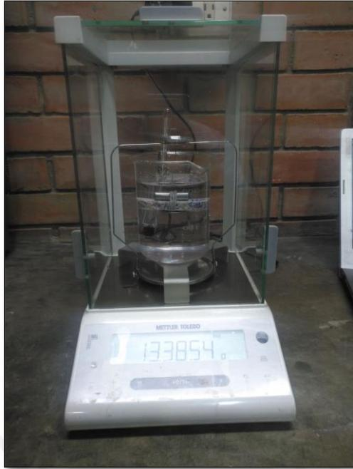
**Figura 2.27.** Peso de la muestra sumergida con el lastre
