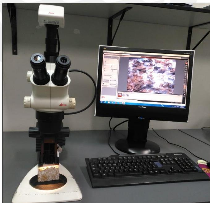
**Figura 2.29.** Estereoscopio óptico
