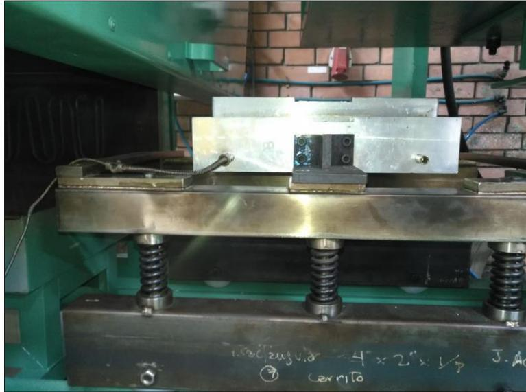
**Figura 2.20.** Molde precalentando cargado con su tapa antes de ingresar al horno
