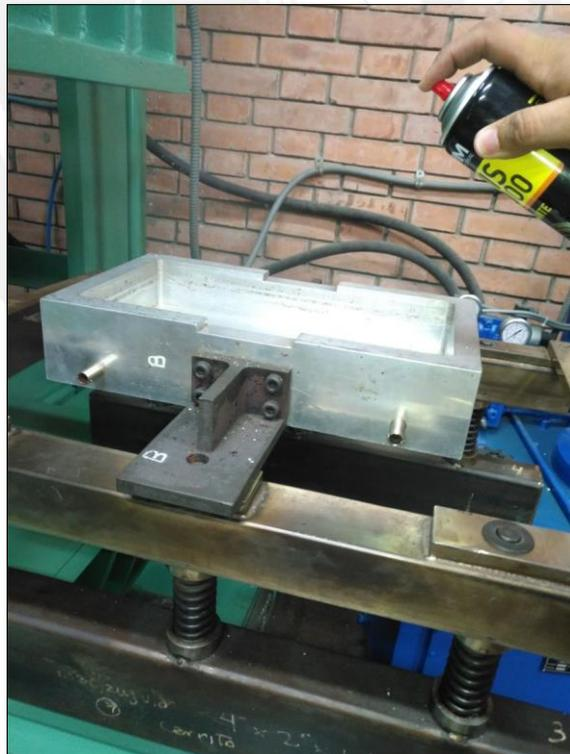
**Figura 2.17.** Aplicación del desmoldante
