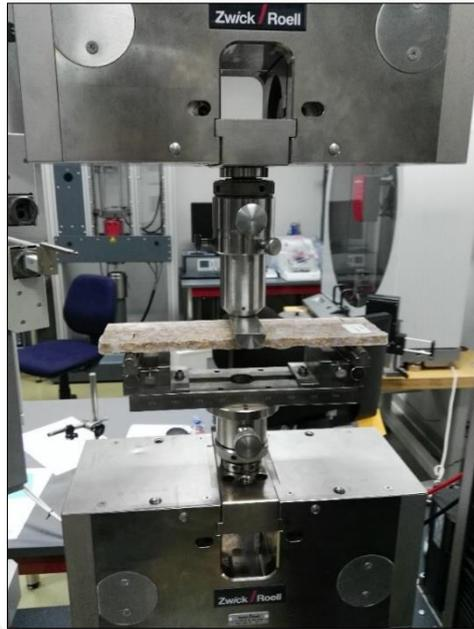
**Figura 2.25.** Máquina de Flexión Zwick/ Roell Z050
