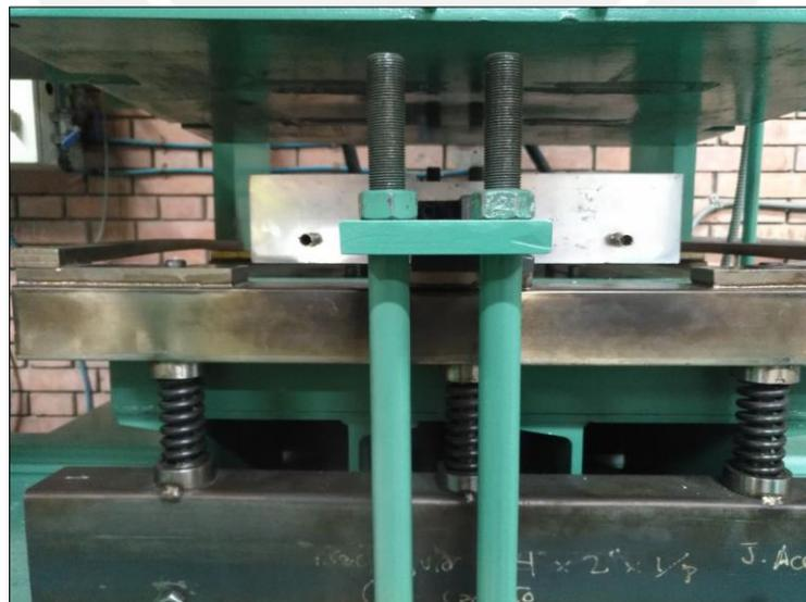
Figura 2.13. Sistema de extracción
