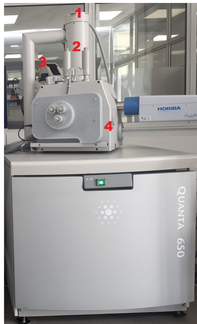
Figura 3.4: Equipo SEM/EDX (Centro de Caracterización de Materiales - PUCP): (1) Cañón de electrones, (2) Sistema de lentes, (3) Detectores y (4) Cámara para la muestra
