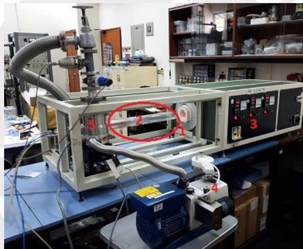
Figura 3.2: Equipo de Horno Tubular del Laboratorio de Materiales, Sección Física (PUCP): (1) Tubo de cuarzo, (2) Muestra, (3) Controladores de temperatura, (4) Bomba mecánica, (5) Bomba turbo.
