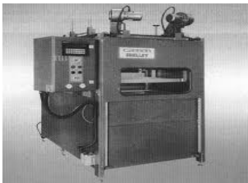
Figura 101. Sistema automatizado de pulido y barnizado de piezas.
