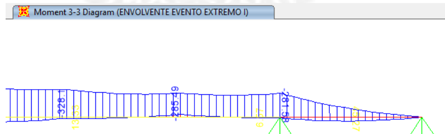
Diagrama de Momentos Flectores – Figura 4.1.2.2.9
