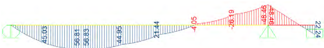
Diagrama de Momentos Flectores – Figura 4.1.2.9
