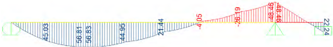
Diagrama de Momentos Flectores – Figura 4.1.2.13
