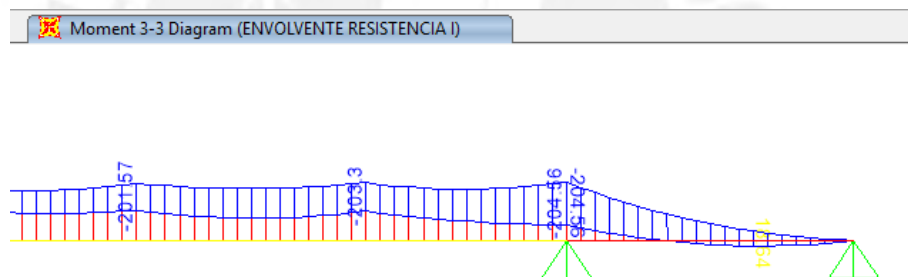
Diagrama de Momentos Flectores – Figura 4.1.2.2.9
