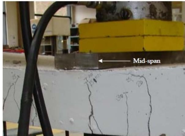
**Figura 36.-** Detalle de falla tipo 3
