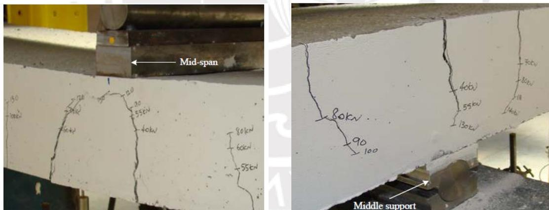
**Figura 35.-** Detalle de falla tipo 2: Primero en la mitad del tramo (derecha) y luego en la mitad de soporte (izquierda)
