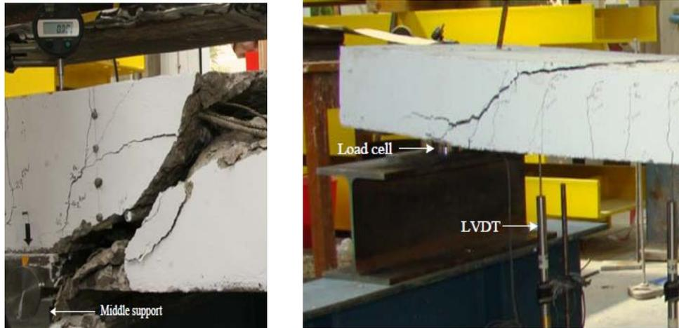
**Figura 34.-** Detalle de falla tipo 1(Primero falla en mitad de soporte (derecha) y luego falla en corte en el extremo (izquierda)
