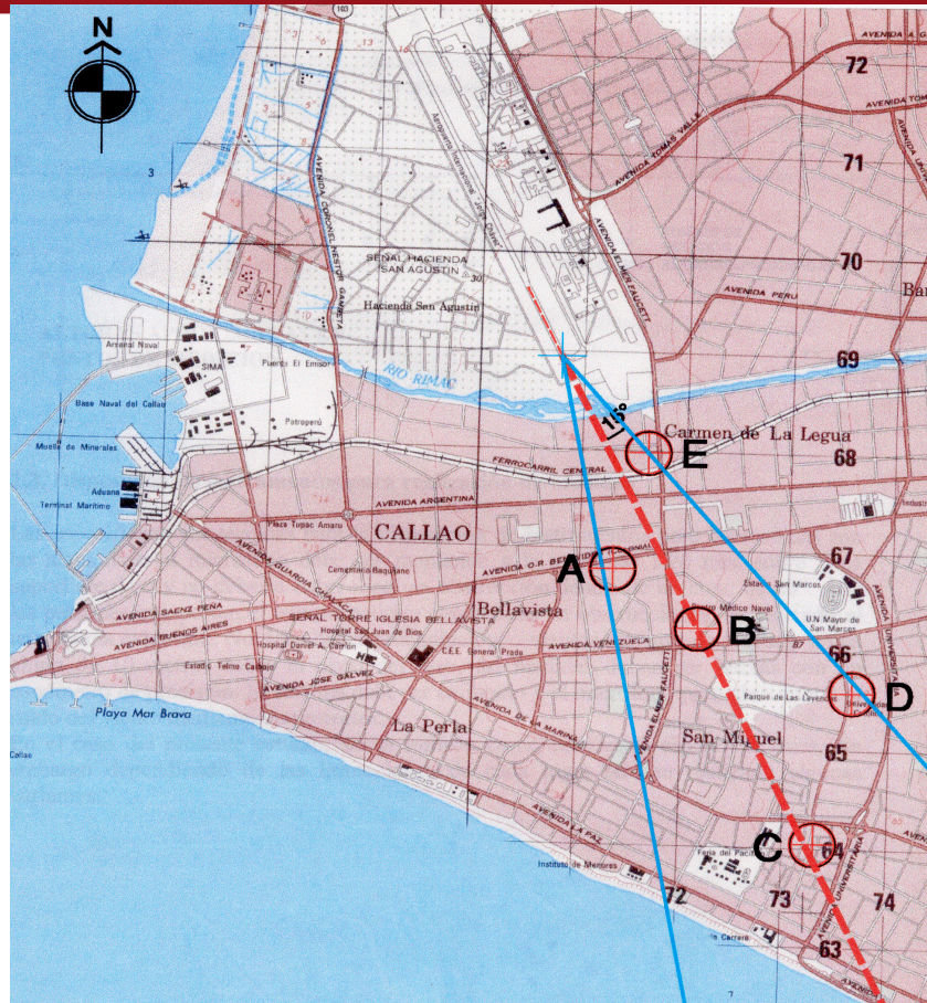
Figura 7.2.9 Puntos de medida al exterior del aeropuerto. Se escogieron puntos dentro del cono de 30^{\circ} que se les permite a los pilotos para maniobrar.
