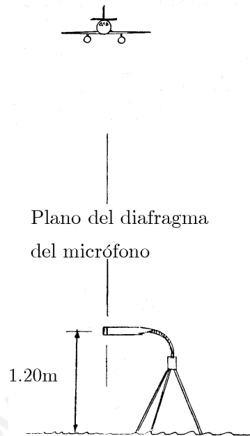
Figura 6.2.2 Disposición del micrófono durante la medición en el proceso de certificación
