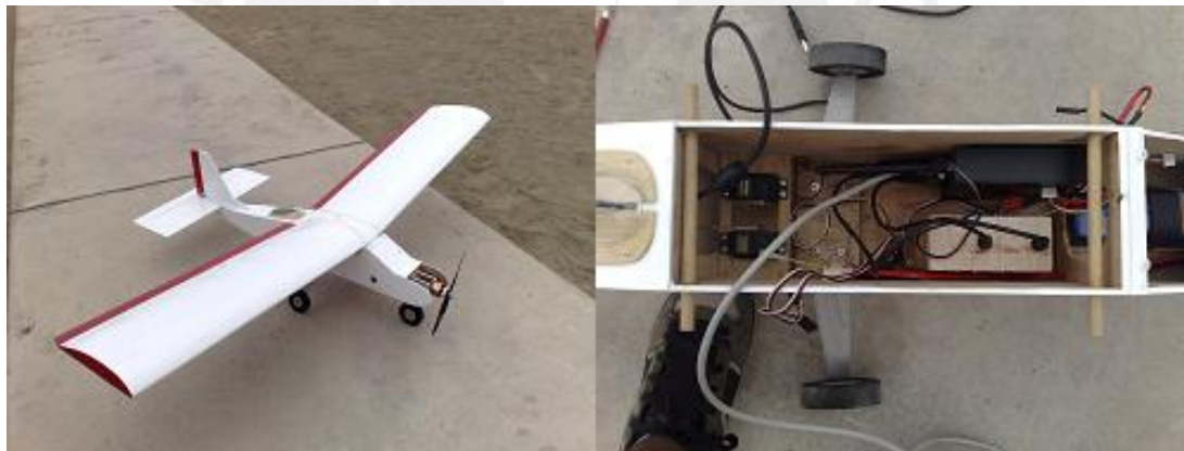
Figura 2.5: FITPC2 montado en el aeromodelo.
