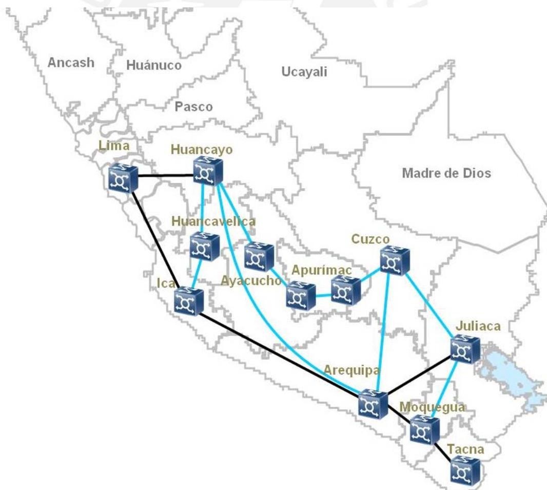
**FIGURA 4-4: ESQUEMA DE RED ASON PARA PERU**
