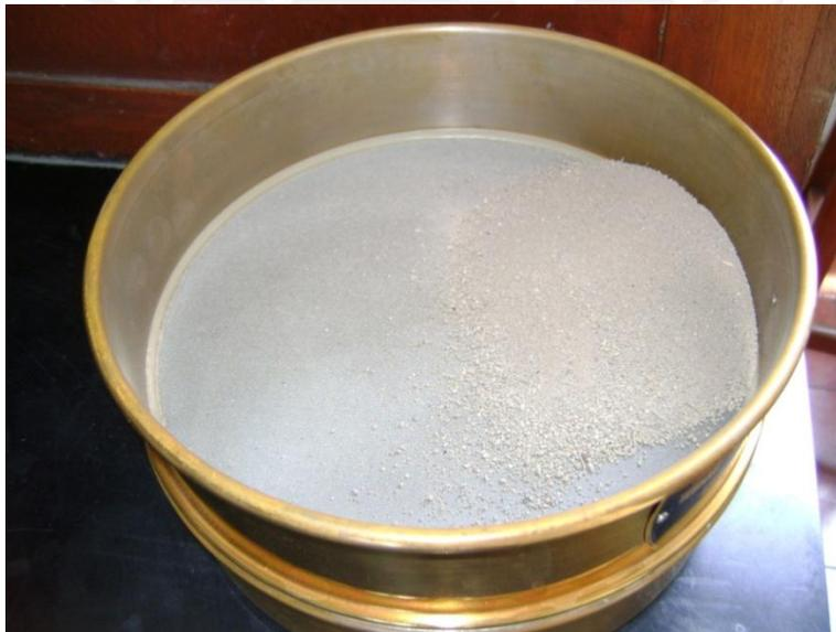
Figura 28. Proceso de tamización de la muestra de suelo
