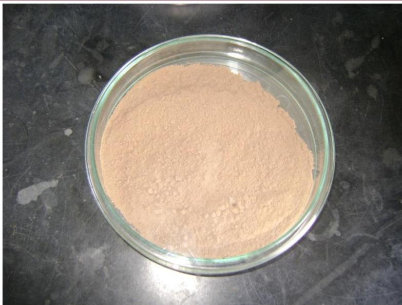
Figura 29. Muestra de suelo después de triturada y tamizada
