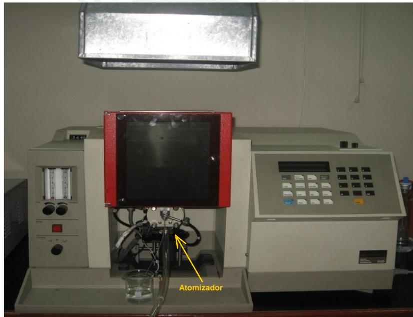
**Figura 9. Espectrofotómetro AAS de flama. Sección Química-PUCP.
