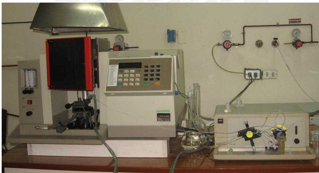
**Figura 11.** Espectrofotómetro AAS, Perkin Elmer modelo 3110, acoplado a un sistema de inyección de flujo, Perkin Elmer modelo FIAS 100. Técnica CV-AAS (Instituto de Corrosión y Protección-PUCP)
