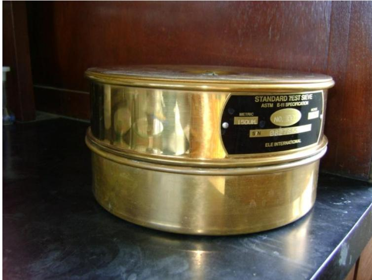
Figura 27. Tamizador ASTM
