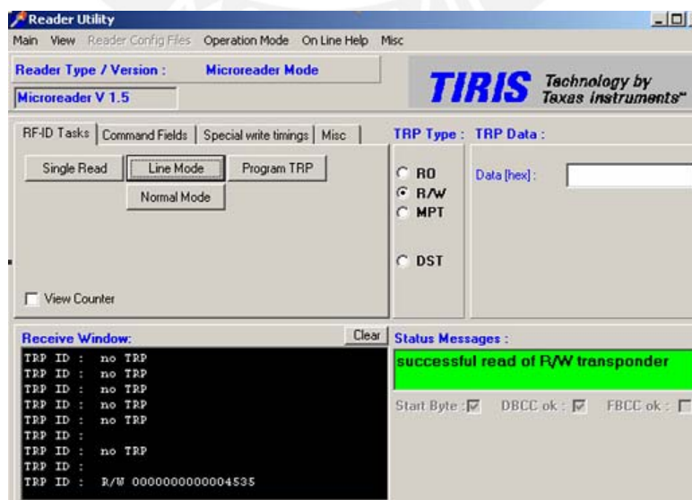
Imagen 4.9 Detección de la tarjeta RFID con ID 0000000000004535.
