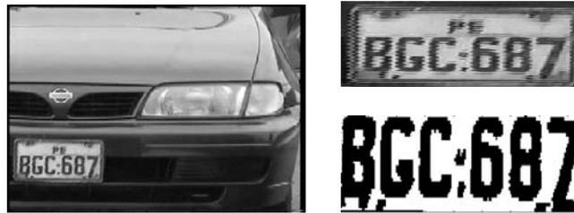
**Figura 2.28** Imagen de una placa con deterioro en sus esquinas. Se muestra como la umbralización de la placa ocasiona una deformidad del carácter B y 7.
