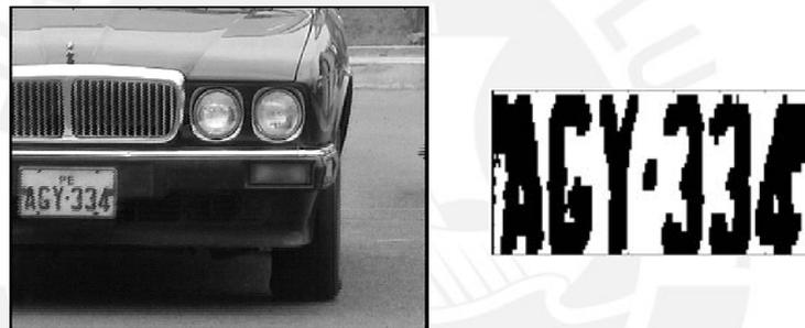
**Figura 2.30** Error en el corte de los extremos
