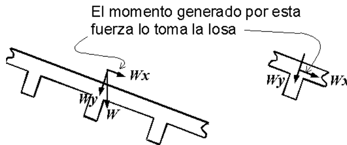
Fig. 9-3 Losa o techo inclinado.
