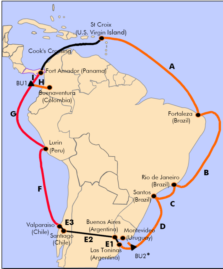
Figura 2-9: Segmentos del Sistema de Cable Submarino SAC Fuente: [Alcatel Lucent Technologies]
