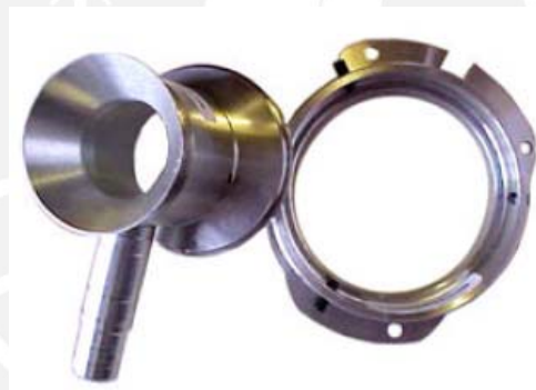
Figura 20a. Mezclador aire-gas natural [16]
