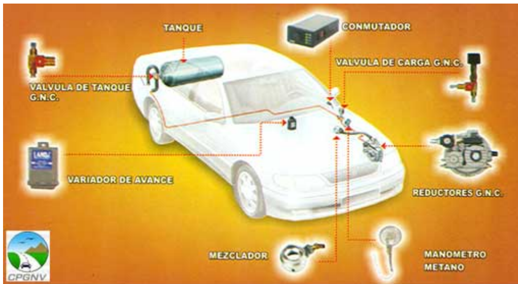
Figura 2. Sistema general de un vehículo convertido a GNV [10]
