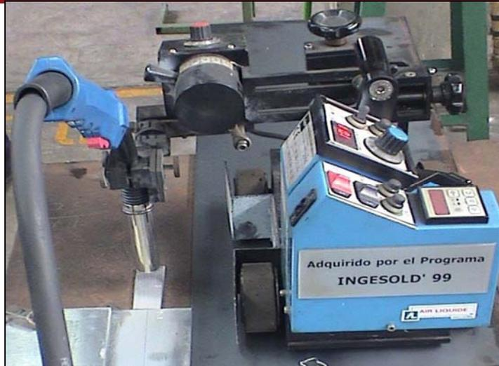
Figura 17. Carro de soldadura (Welding Car) MIG-Semiamatomatica
