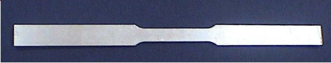
**Figura 27.** Probetas de Ensayo de Tracción
