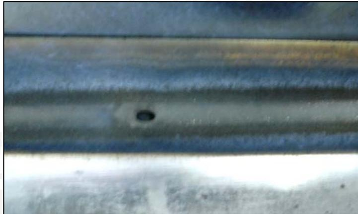
**Figura 35.** Perforación en el cordón de soldadura.
