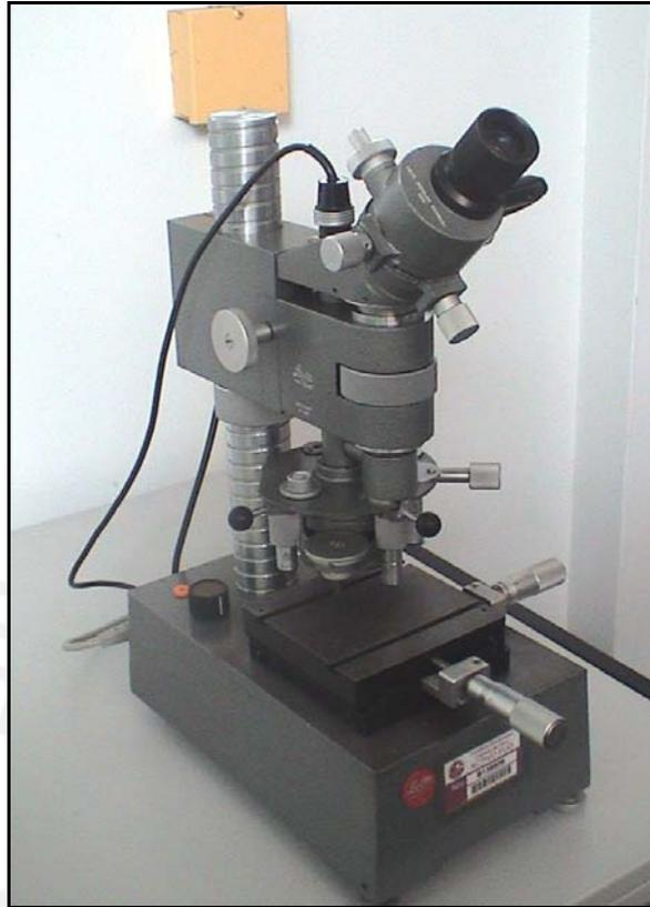
**Figura 31.** Equipo de microdureza empleado
