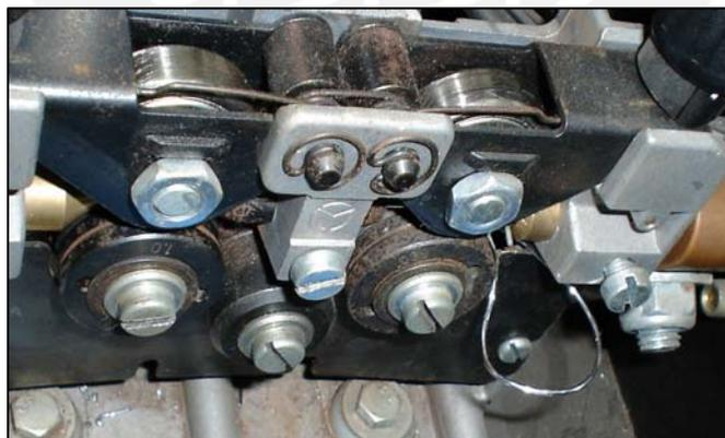
Figura 34. Atascamiento del ER4043 entre los rodillos impulsores.
