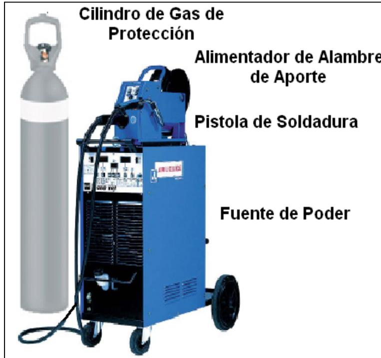
Figura 11. Equipo de soldadura MIG
