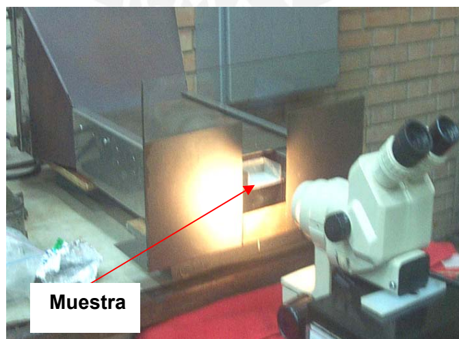
Figura 2.19 Uso del estereoscopio para monitorear sinterizado
