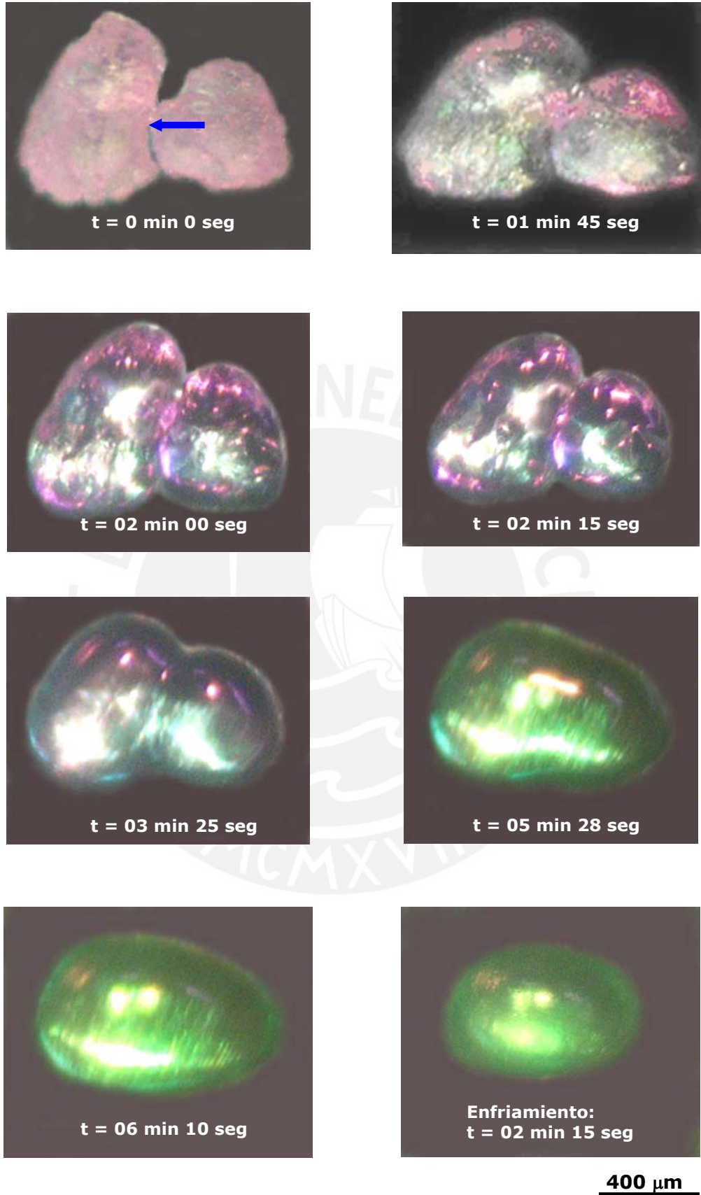
Figura 2.10 Fotomicrografías del sinterizado de dos partículas de HDPE , T = 130°C
