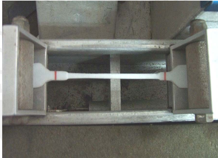
Figura 4.18 Fotografía durante el ensayo de fragmentación.
