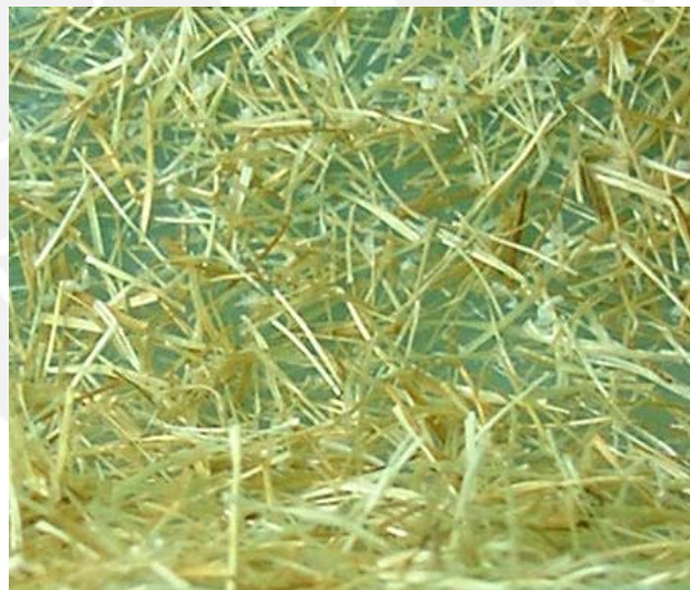
Figura 3.3 Fotografías de fibras de sisal cortadas entre 4-8 mm de largo usados en los compuestos
