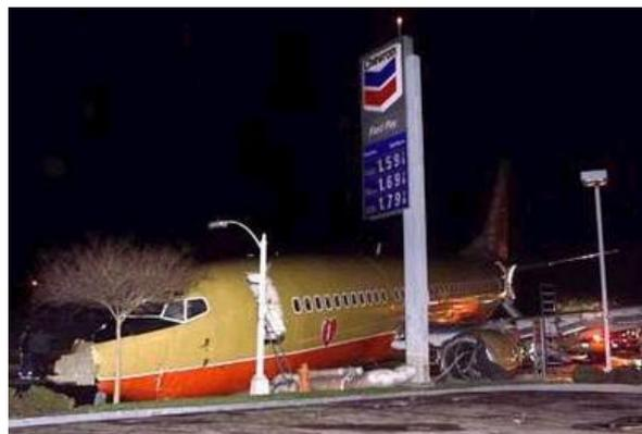
Figura 4.2: La tripulación de este Boeing 737 de Southwest Airlines, cometió un error al iniciar el aterrizaje muy rápido muy lejos del inicio de la pista en condiciones de inestabilidad terminando en una gasolinera cercana al aeropuerto (Marzo 5 del 2000).
