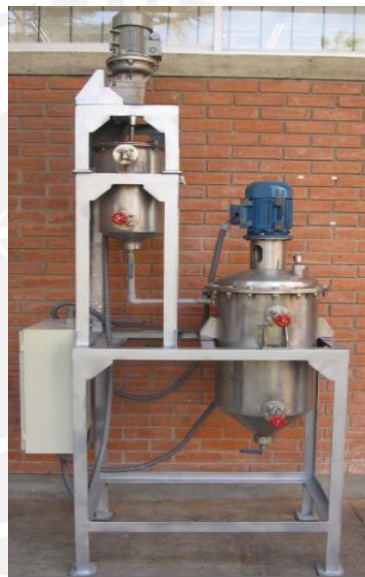
Figura No. 3.1. Módulo de Transesterificación
