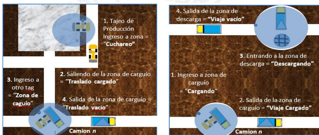
Figura 3. Esquema de triggers en un tajeo para un ciclo de cargador de bajo perfil y un camión. Fuente del autor.
