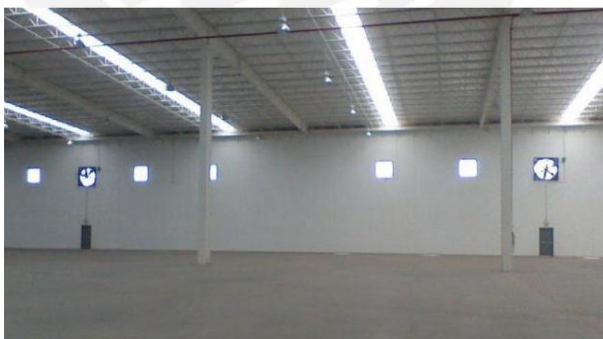
Figura 1. 1: Interior de un edificio industrial, provisto de un techo aligerado no aislado, que consta con un mecanismo de ventilación; para el control de la carga térmica [1].
