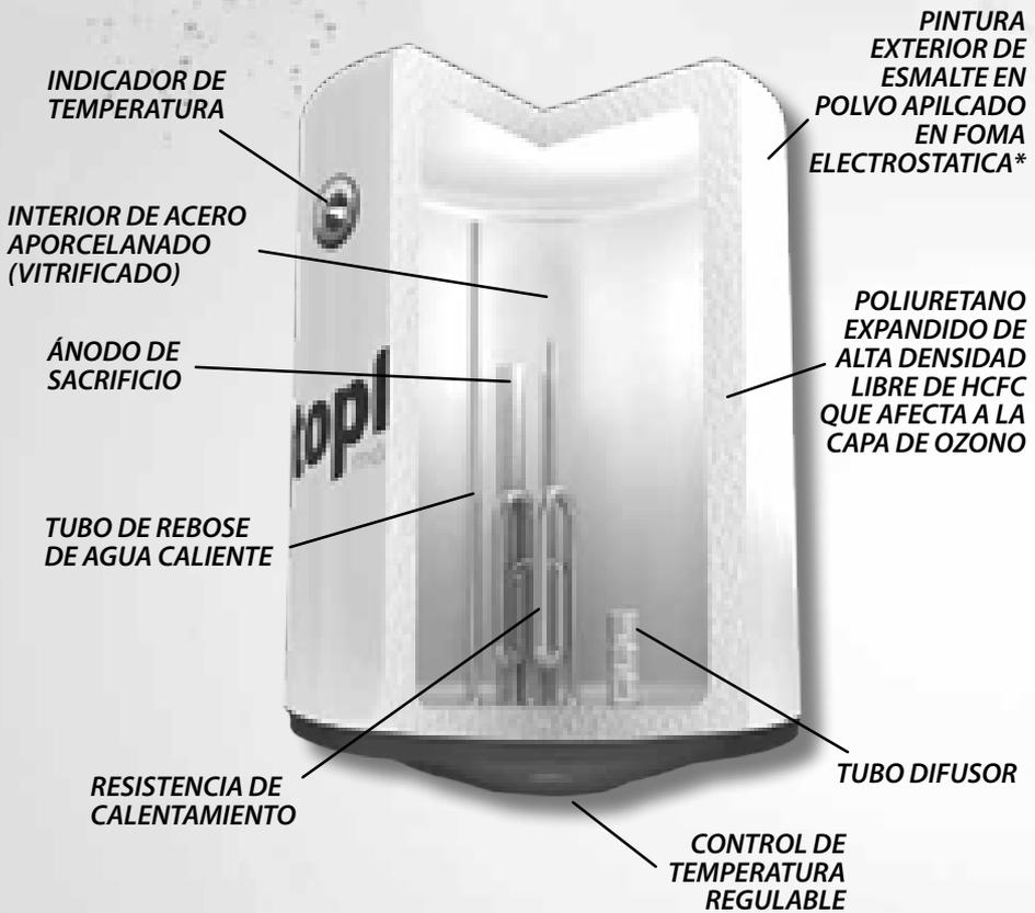
\* Los modelos de 15 y 30 lt, tienen cubierta exterior de polipropileno.
