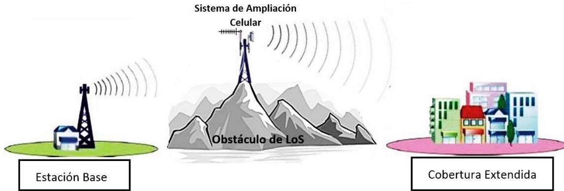
Figura 1.4 Aplicación del sistema de ampliación celular en ambiente *Outdoor* donde no existe LoS
