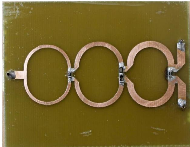
Figura 3.36 Divisor de potencia Wilkinson de banda ancha
