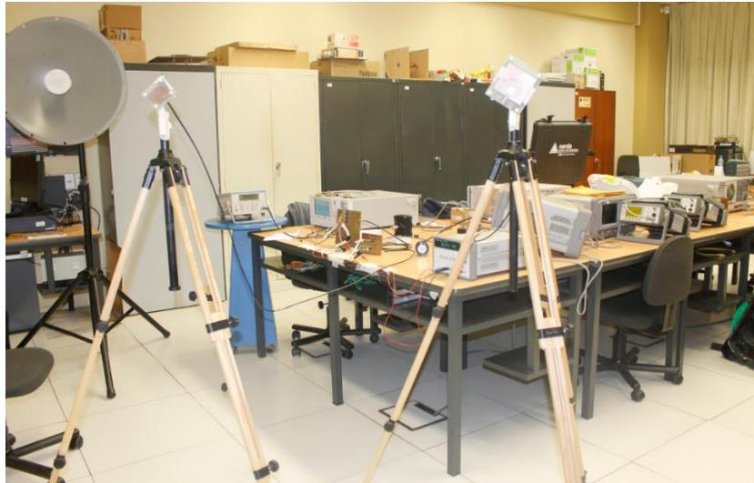
Figura 4.19 Escenario de evaluación del sistema de ampliación celular, incorporando dos antenas selectivas de las bandas de frecuencia en 850 MHz y 1900 MHz.
