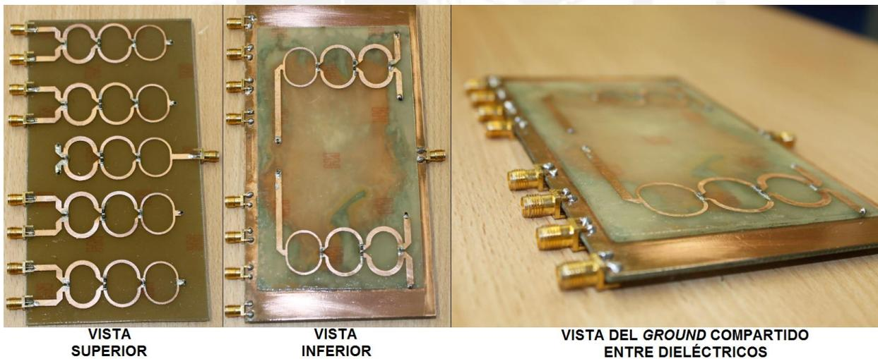
Figura 3.41 Divisor de potencia Wilkinson de banda ancha implementado con un factor de distribución de 1 a 8
