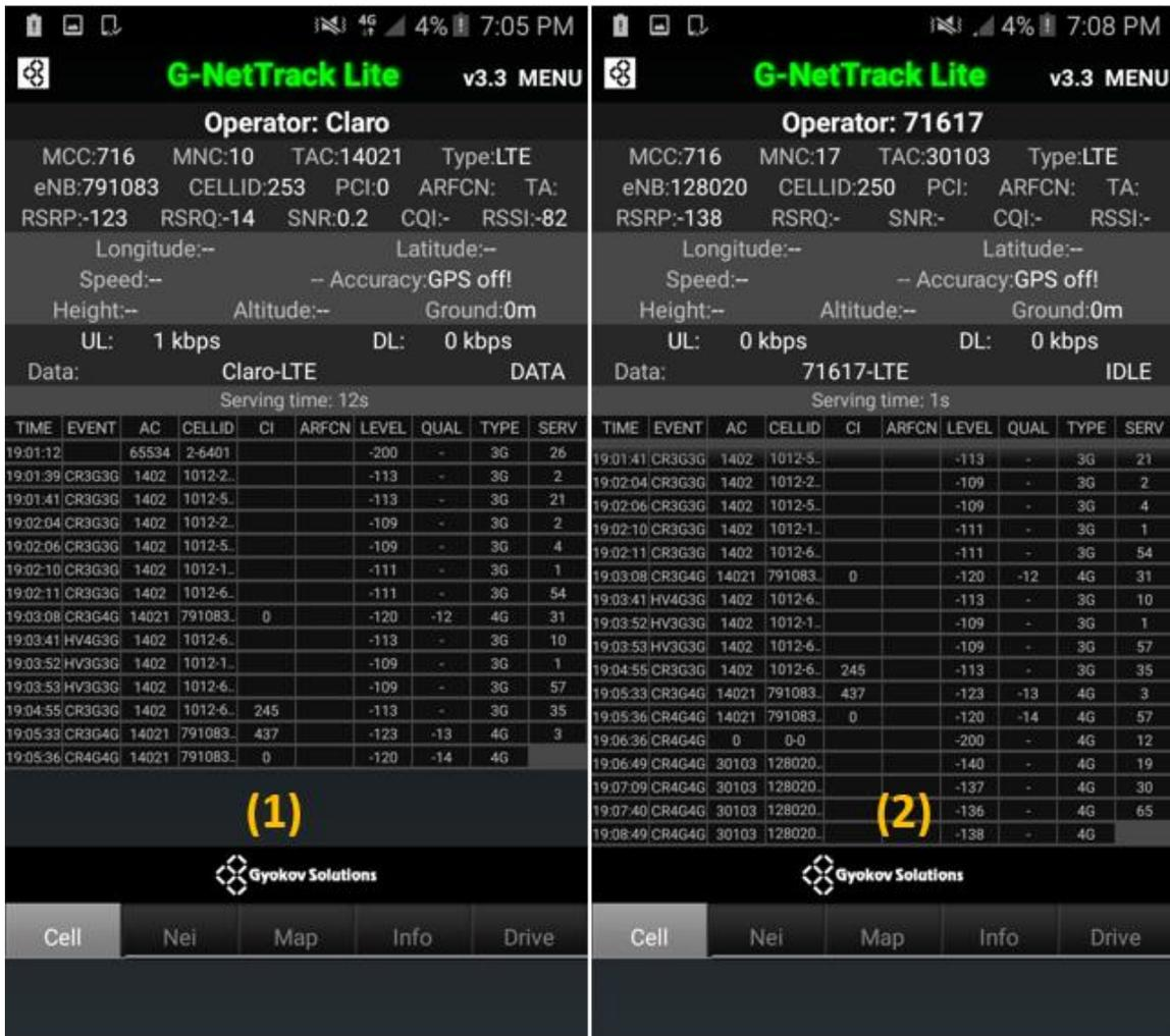
Figura 4.21 Nivel de potencia de RSSI en móvil en un ambiente sin cobertura móvil con el sistema de amplificación activo (1) y sin la presencia del mismo (2).
