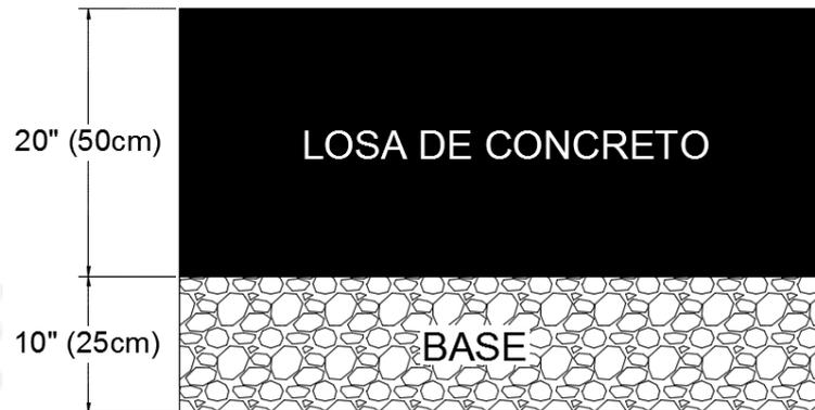
Figura 29. Sección Área Crítica para 10” de subbase (valores en pulgadas).
