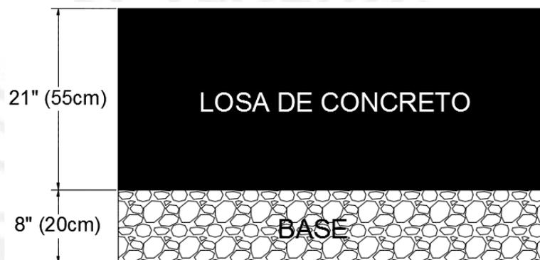
Figura 28. Sección Área Crítica para 8” de base. Fuente: Propia
