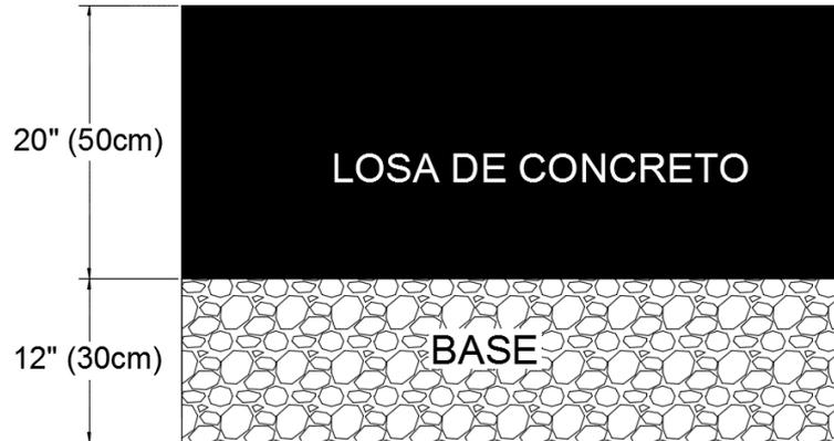
Figura 30. Sección Área Crítica para 12" de subbase. Fuente: Propia
