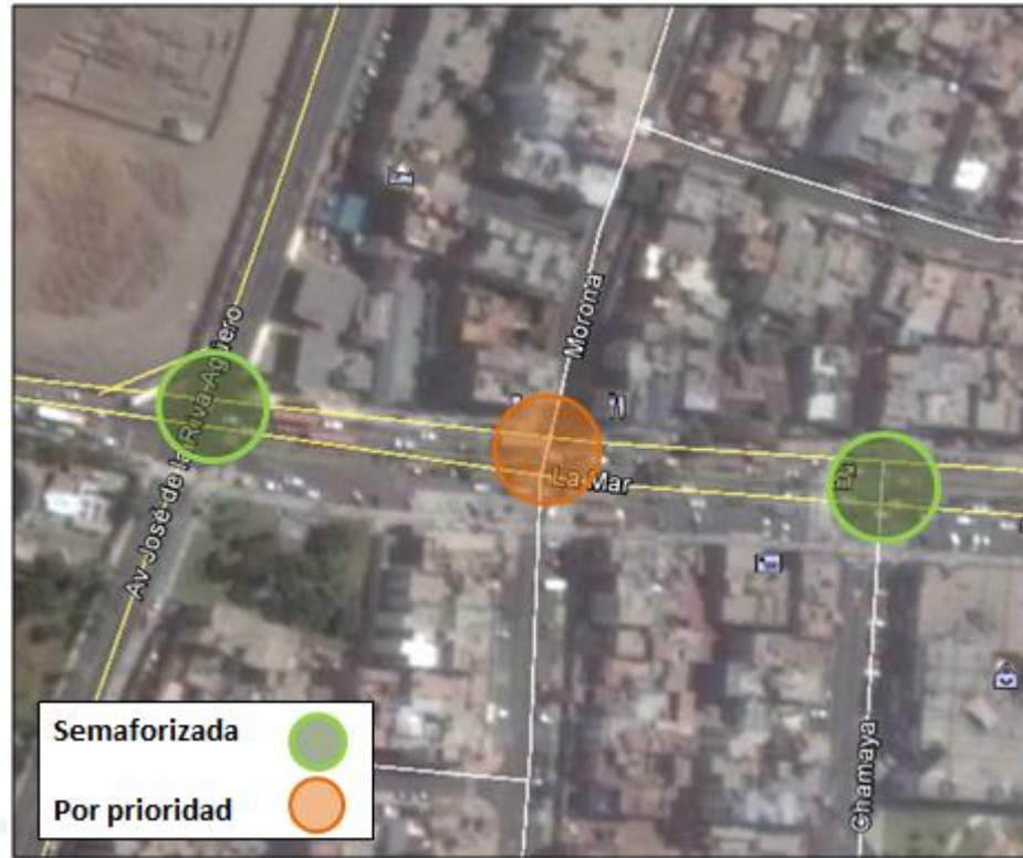
Figura 33. Regulación de intersecciones cercanas
