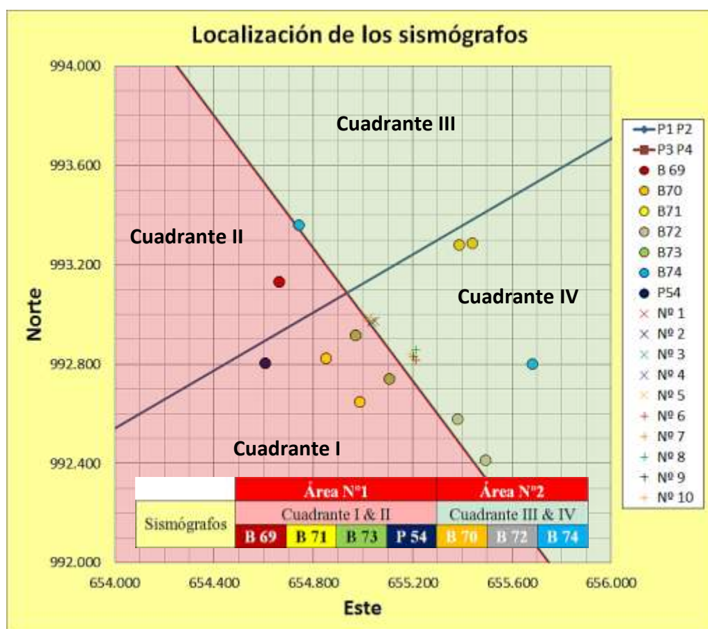
Figura 60.- Distribución de los sismógrafos sobre el terreno.
