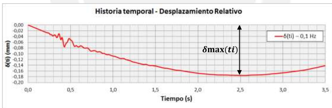
Figura 38.- Historia temporal para el desplazamiento relativo de una estructura con una frecuencia natural de 0,1Hz.
