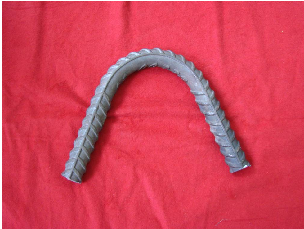
Figura 3.07: Probeta de doblado de barra de 1" ensayada.
