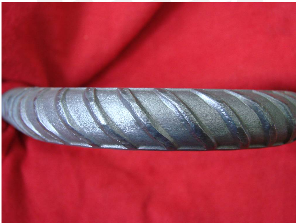
Figura 3.06: Superficie de la cara exterior de la probeta de doblado de barra de 3/4".
