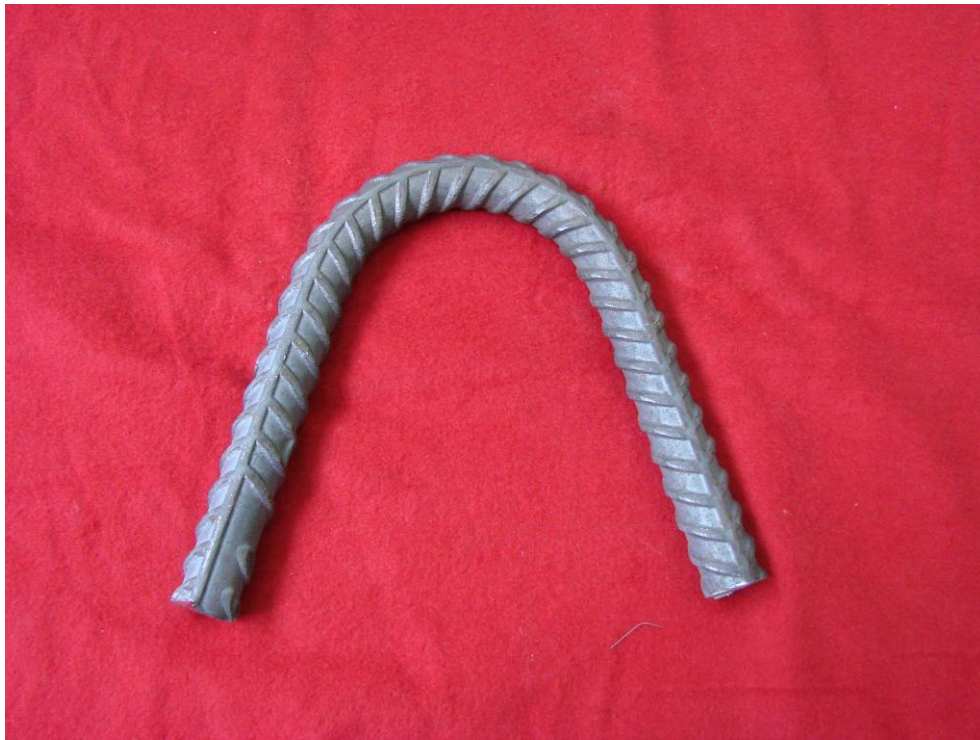
Figura 3.05: Probeta de doblado de barra de 3/4" ensayada.
