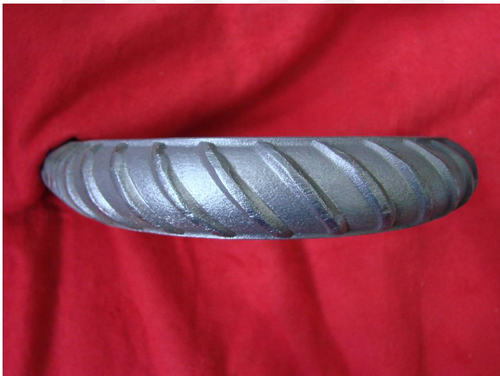
Figura 3.08: Superficie de la cara exterior de la probeta de doblado de barra de 1".
