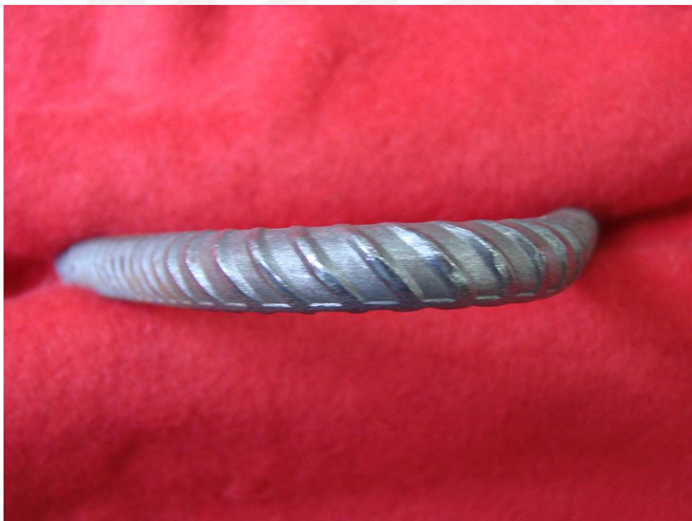
Figura 3.02: Superficie de la cara exterior de la probeta de doblado de barra de 3/8".
