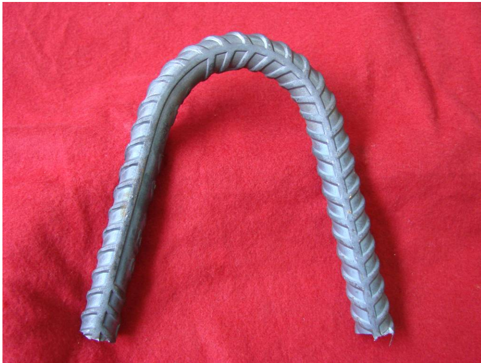
Figura 3.03: Probeta de doblado de barra de 5/8" ensayada.
