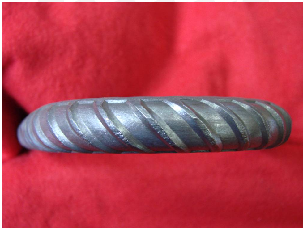
Figura 3.04: Superficie de la cara exterior de la probeta de doblado de barra de 5/8".
