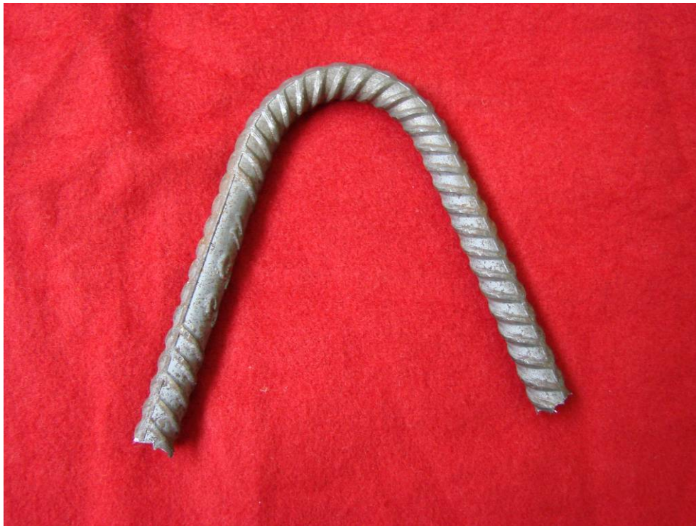
Figura 3.01: Probeta de doblado de barra de 3/8" ensayada.
