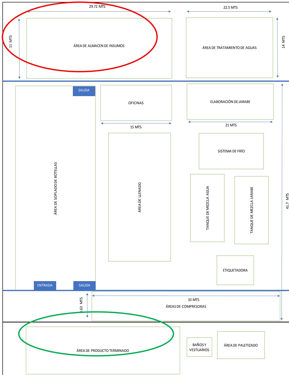
Figura 46. Almacenes dentro de la planta de bebidas no alcohólicas.
