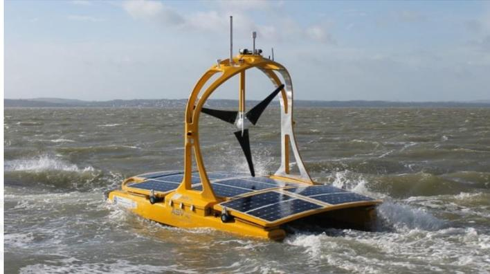
Figura 1.6. Vehículo de superficie modelo *C-Enduro* (ASV *unmanned marine systems*)
