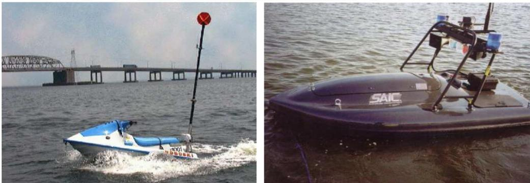
Figura 1.2. Vehículos marítimos en operación. *Roboski* (izquierda) y robot de búsqueda *Owl MK II* (derecha) (Bertram, 2008)
