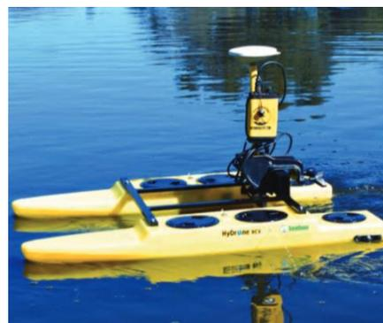
Figura 1.5. Vehículo de superficie modelo *Hydrone-RCV* (*Seafloor Systems Inc.*)
