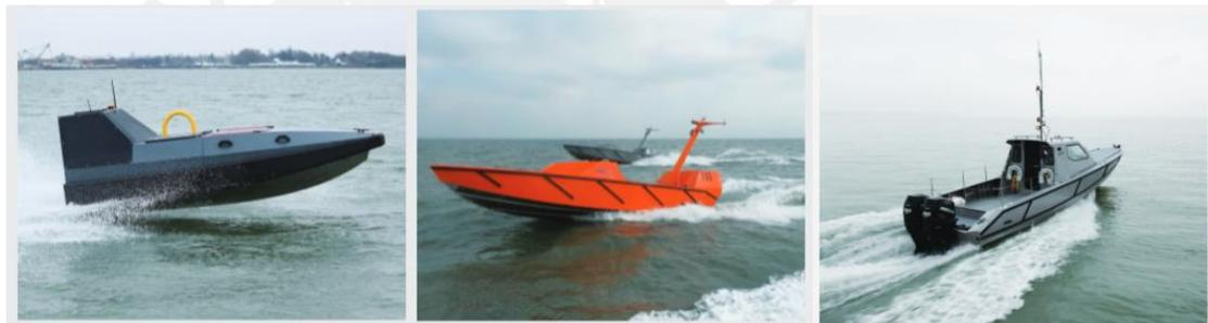
Figura 1.4. Vehículos marítimos fabricados por *ASV unmanned marine systems*. Modelos *C-Target 3*, *C-Target 9* y *C-Target 13* (de izquierda a derecha)
