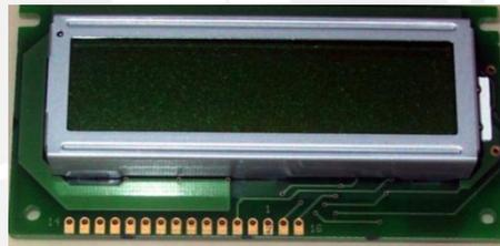
Figura 2: Pantalla LCD 16x2
