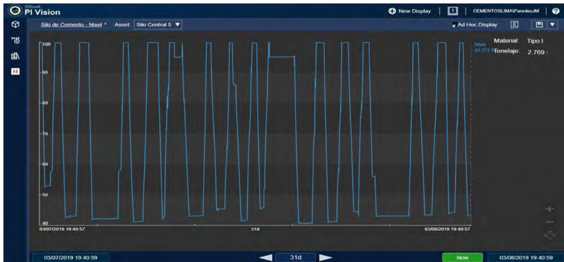
Figura 47. Intervalos de reabastecimiento para el cemento tipo I. Tomado de Sistema PI Vision UNACEM, Lima, Perú.
