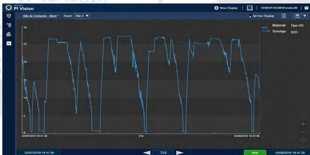
Figura 49. Intervalos de reabastecimiento para el cemento tipo HS. Tomado de Sistema PI Vision UNACEM, Lima, Perú.
