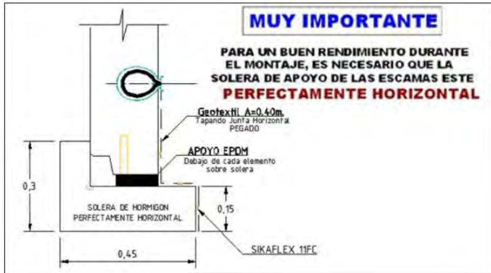
Figura 10. 4 Construcción de solera de concreto para el montaje de paneles. . Fuente: (Freyssinet Tierra Armada, 2015)
