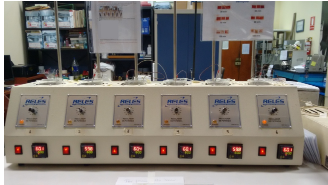
Figura 3.3: Sistema de grabado termoestabilizado del laboratorio de Huellas Nucleares de la PUCP
