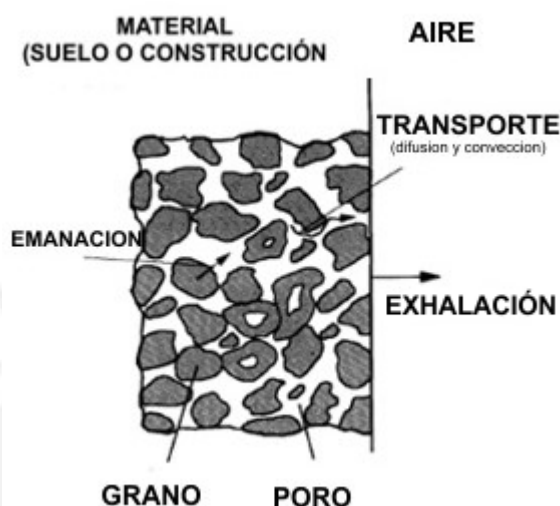
Figura 1.4: Transporte de Radón en suelo y materiales de construcción [52].
