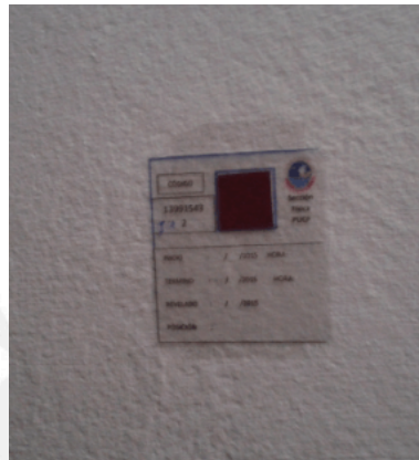
Figura 3.10: Detector LR-115 tipo 2 adherido sobre la pared en el interior de una vivienda.
