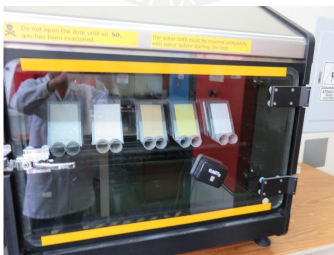
Figura 16. Ingreso de probetas a cámara de SO 2 húmedo e inicio de ensayo acelerado.
