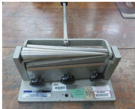
Figura 14. Equipo de mandril cónico usado para los ensayos de flexión de los recubrimientos.
