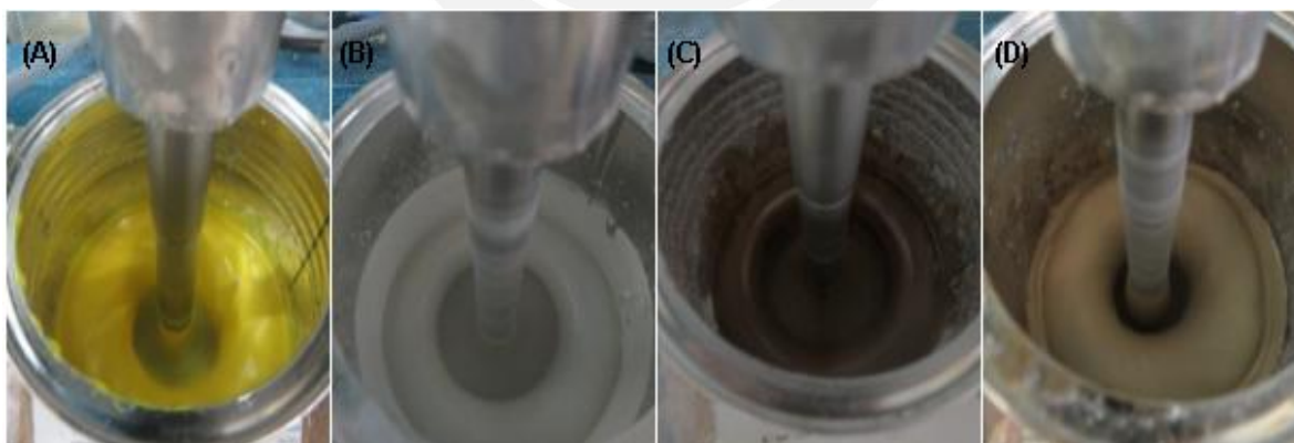
Figura 13. Efecto doughnut en los imprimantes formulados (Etapa 1). (A) EP-Cr, (B) EP-F, (C) EP-T3, (D) EP-T4.
