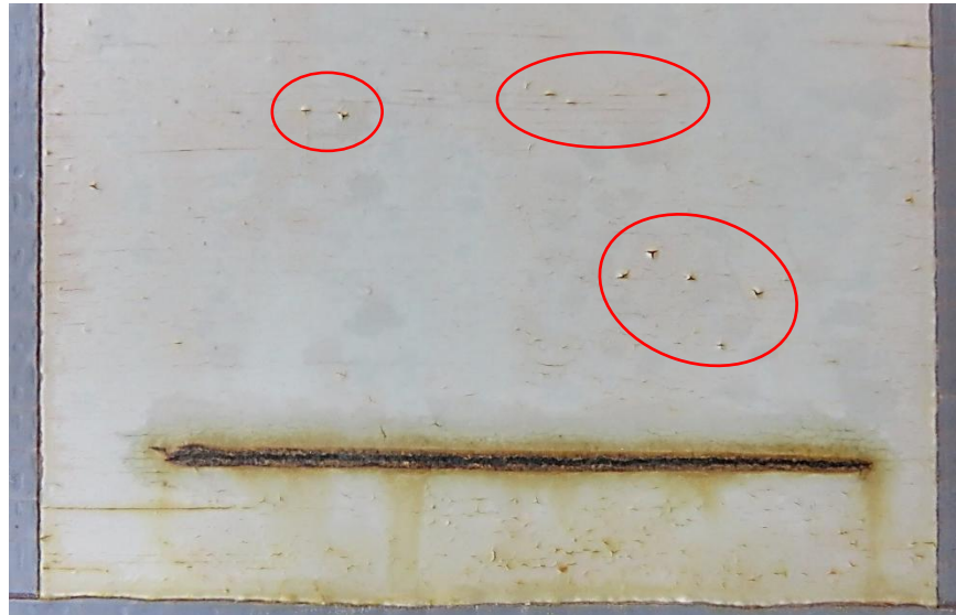
Figura 27. Agrietamiento presentado en probeta PCr-07. Vista inferior de la probeta.
