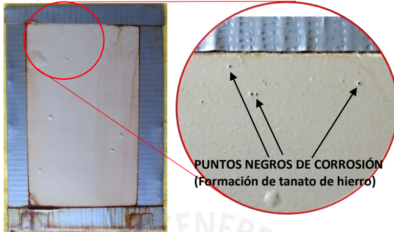
Figura 24. Formación de tanato de hierro en probeta PT3-15.
