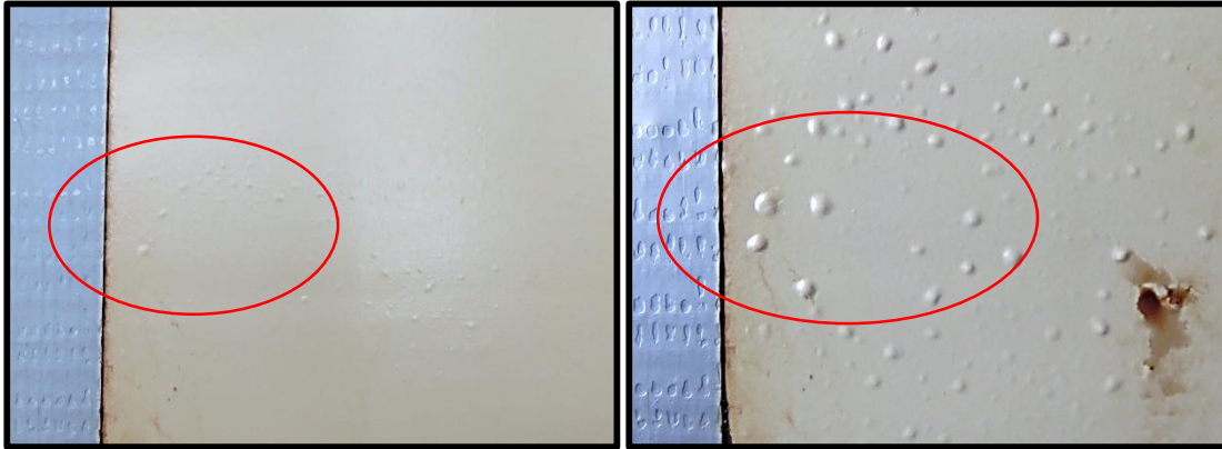
Figura 30. Crecimiento de tamaño y densidad de ampollas en probeta PCr-35. (izq.) Grado 8F, 1008 horas o 42 ciclos. (der.) Grado 4MD, 3024 horas o 126 ciclos.
