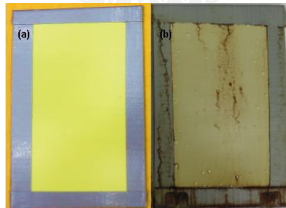
Figura 25. Comparación de color y brillo de la probeta PCr-05. (a) Antes de iniciar el ensayo. (b) Finalizado el ensayo.
