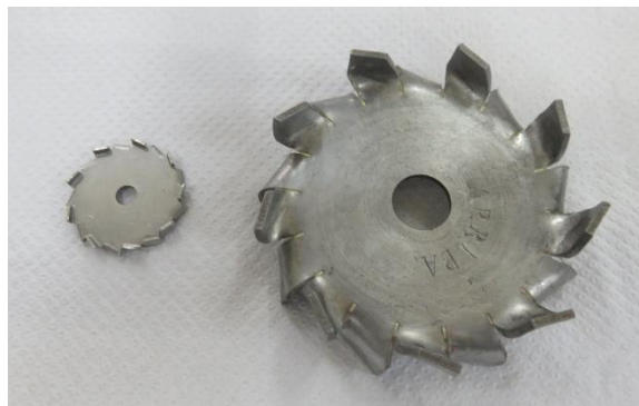
Figura 12. Discos agitadores tipo cowles. (Izquierda) de \phi 30mm. (Derecha) de \phi 70mm.
