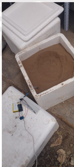
Figura 4.2: Calibración del sensor de humedad y temperatura [Elaboración propia]
