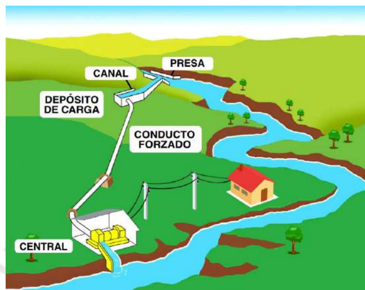
Figura 1: Esquema de pequeña central hidroeléctrica. (Fundación Red de Energía BUN-CA, 2018)
