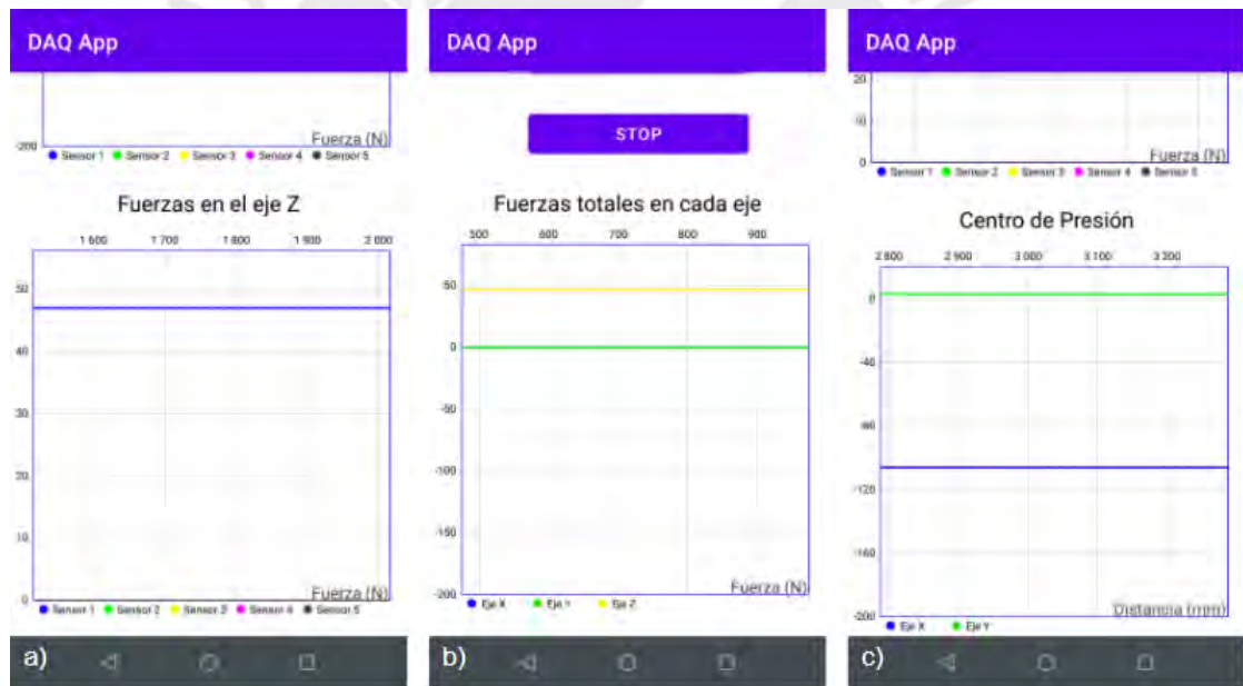
Figura 4.8: Gráficas de la aplicación móvil. a) Fuerzas en el eje Z. b) Fuerzas totales. c) Centro de presión.
