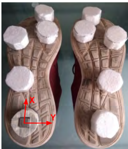
Figura 4.13: Zapatillas con sensor adherido y piezas de poliestireno.
