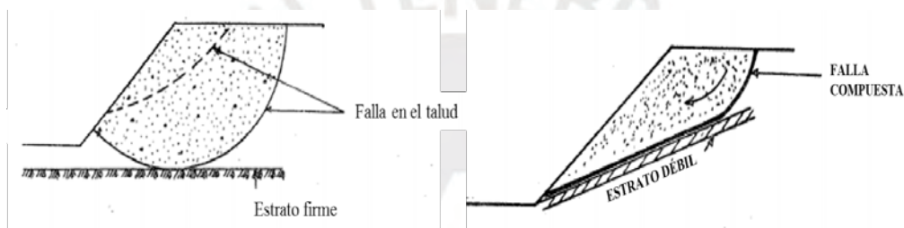
Figura 4: Falla rotacional (izquierda) y falla planar y compuesta (derecha).
