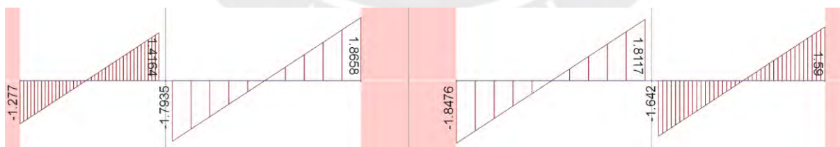
Figura 5-8 DFC para viga V-04 por carga muerta
