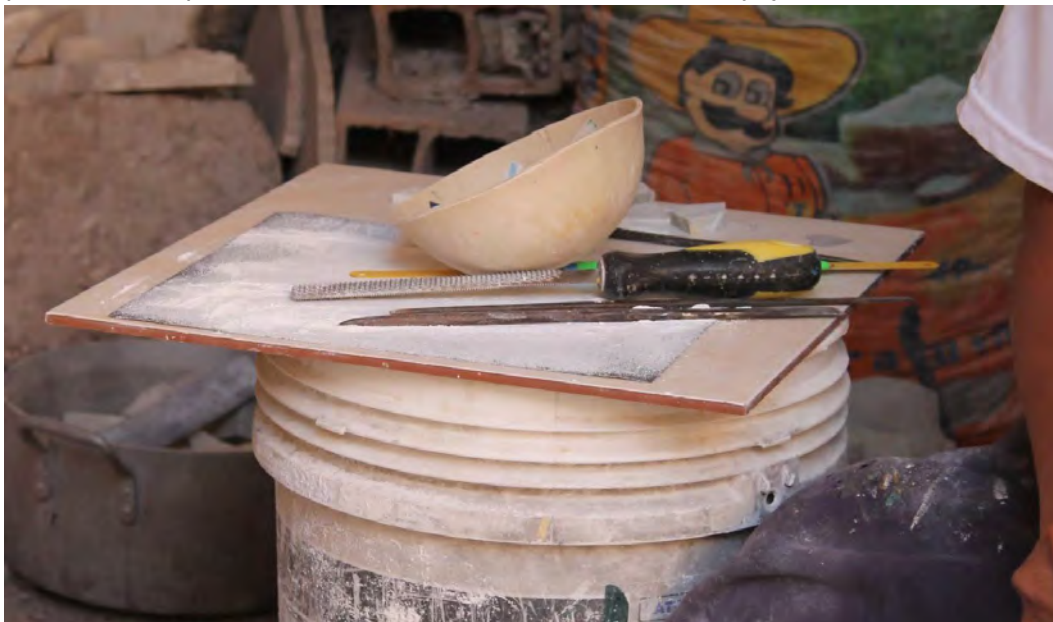
Figura 86. Herramientas más utilizadas por el señor Roger en su taller. Balón de pelota cortado a la mitad que sirve como protector de rodilla, serrucho, escofina, buriles y lija.
